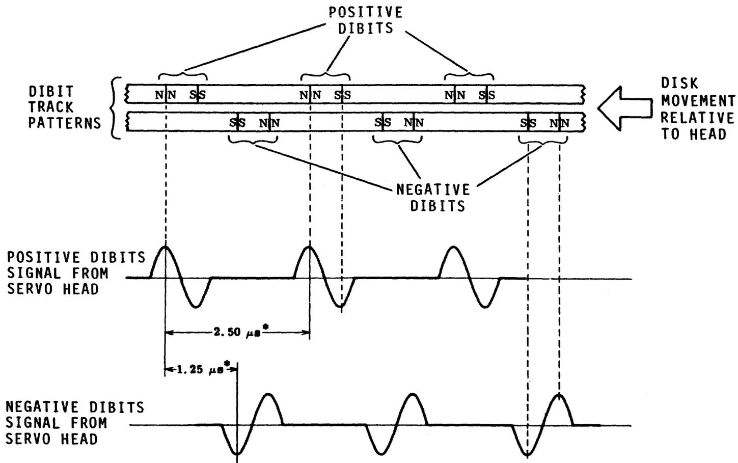
\*INTERVAL AT 3600 r/min DISK SPEED
