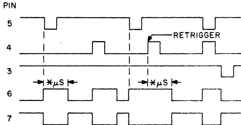
\* PULSE DURATION IS A FUNCTION OF THE RC TIMING NETWORK.
