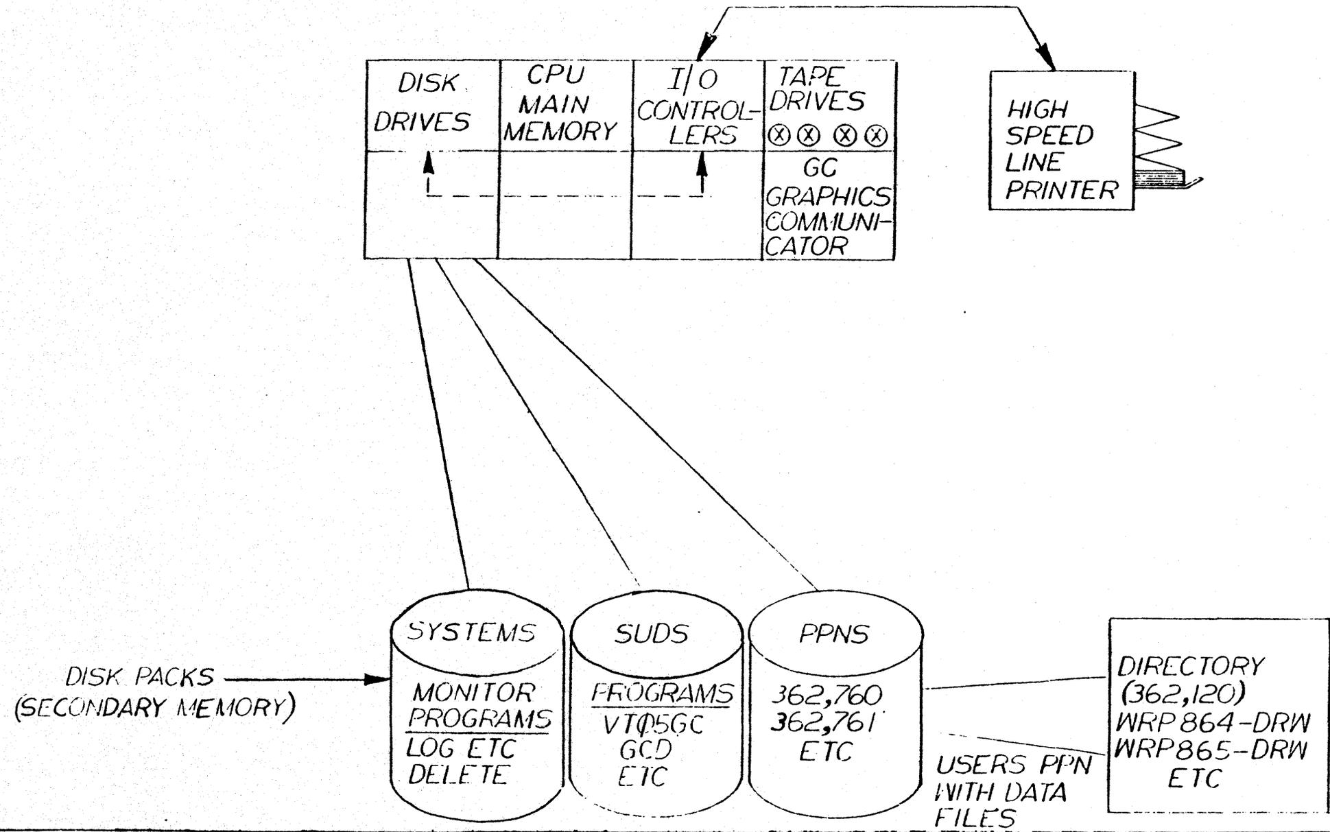
FIGURE 2-1 SUDS SYSTEM CONFIGURATION
