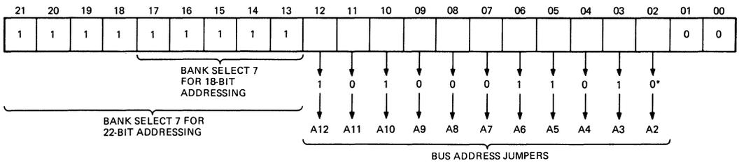
CONNECT TWO POSITION JUMPER CLIPS (PART NO. 12-18783-00) TO DECODE A 1.
