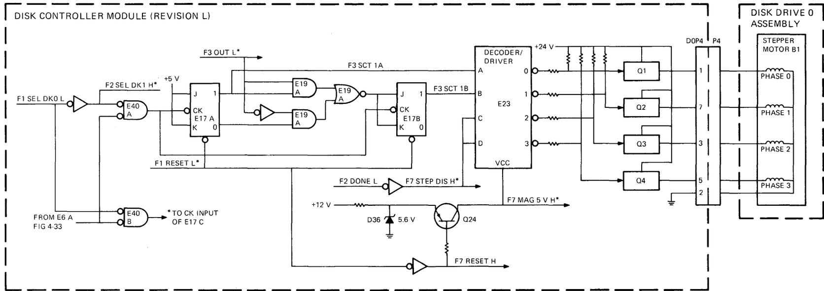
\* TO STEPPER MOTOR CONTROL AND DRIVE LOGIC FOR DISK DRIVE 1 ON DISK CONTROLLER MODULE
