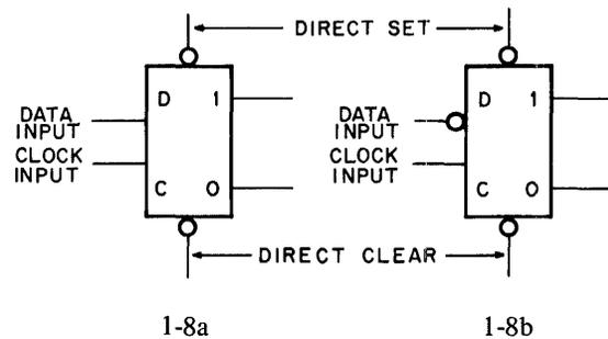
Figure 1-8 D Flip-Flop – Edge Triggered
