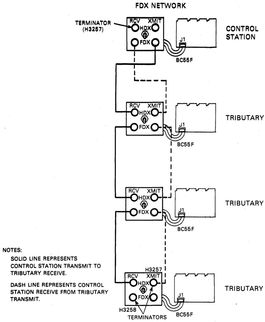
BOTH ENDS OF THE TRANSMIT LINE FROM THE TRIBUTARIES NEED TERMINATION IN ADDITION TO THE ONE TRANSMIT LINE FROM THE CONTROL STATION
