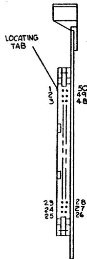
Figure C-1 Connector Edge View
