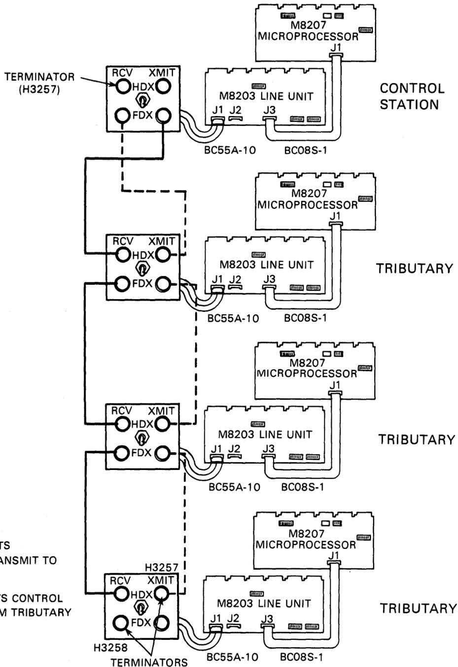
BOTH ENDS OF THE TRANSMIT LINE FROM THE TRIBUTARIES NEED TERMINATION IN ADDITION TO THE ONE TRANSMIT LINE FROM THE CONTROL STATION
