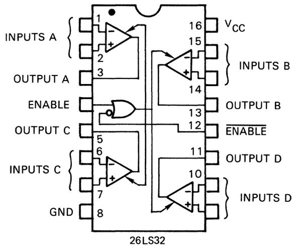
NOTE: PIN 1 IS MARKED FOR ORIENTATION
