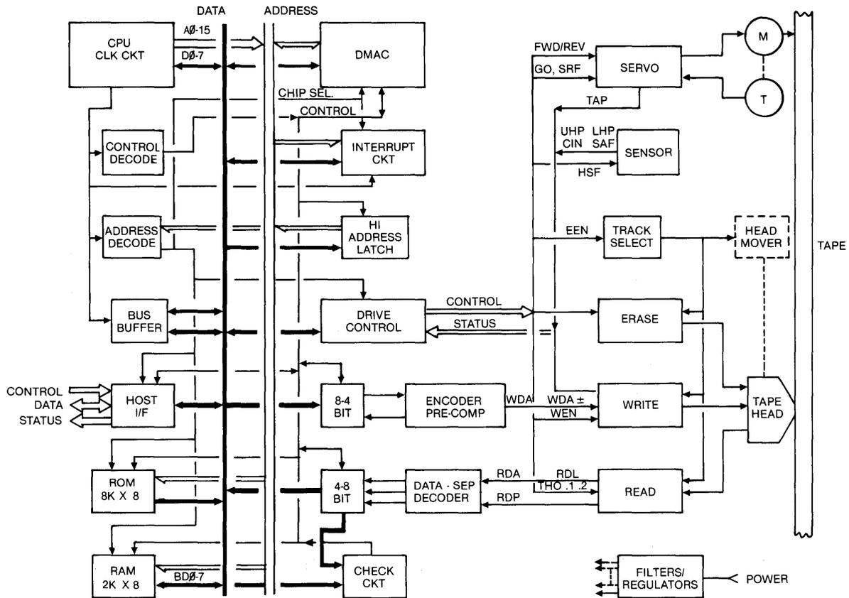
Figure 4-1 STREAMER BLOCK DIAGRAM
