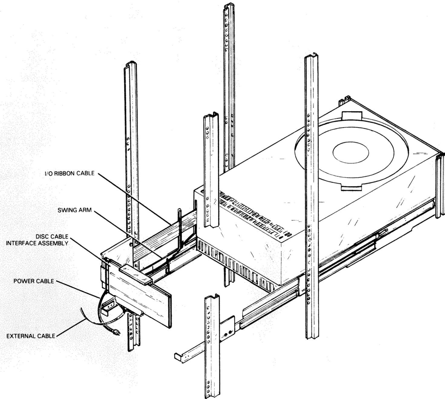
REAR VIEW OF A DISC DRIVE MOUNTED IN A SWING CABINET. DRIVE IS SHOWN PARTIALLY EXTENDED ON THE SLIDE RAILS. NOTE DISC CABLE INTERFACE ASSEMBLY FASTENED TO THE REAR CABINET RAIL; SLACK IN I/O AND POWER CABLES IS TAKEN UP BY A SPRING-LOADED SWING ARM.
