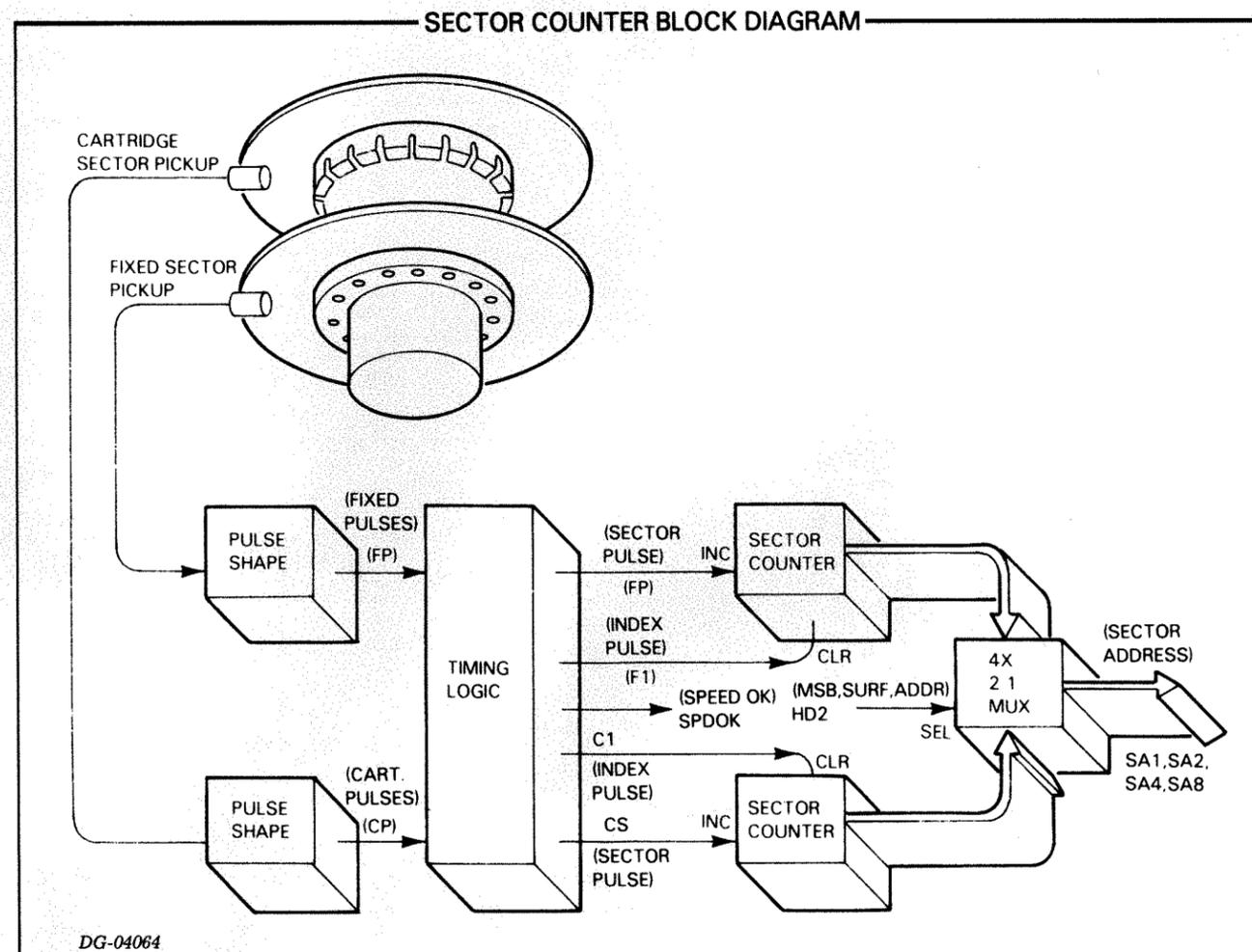
SPINDLE CONTROL & TIMING
