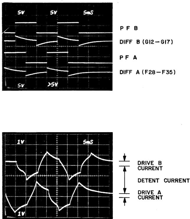
Figure 4-37 PAPER DRIVE WAVEFORMS
