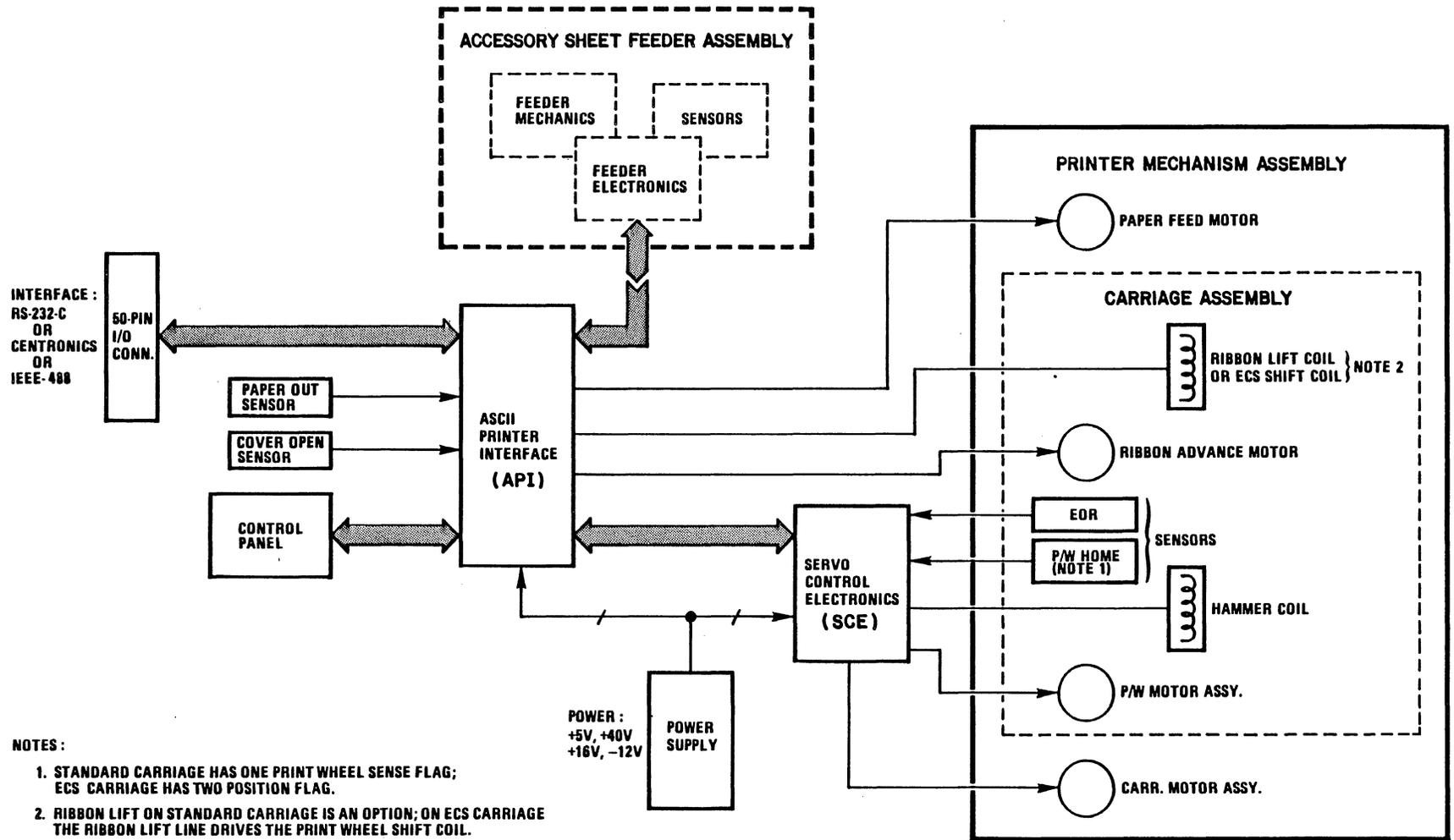
Figure 1-2. MODEL 630 API TERMINAL BLOCK DIAGRAM
