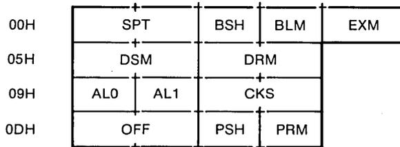
**Figure 6-4. DPB - Disk Parameter Block**
