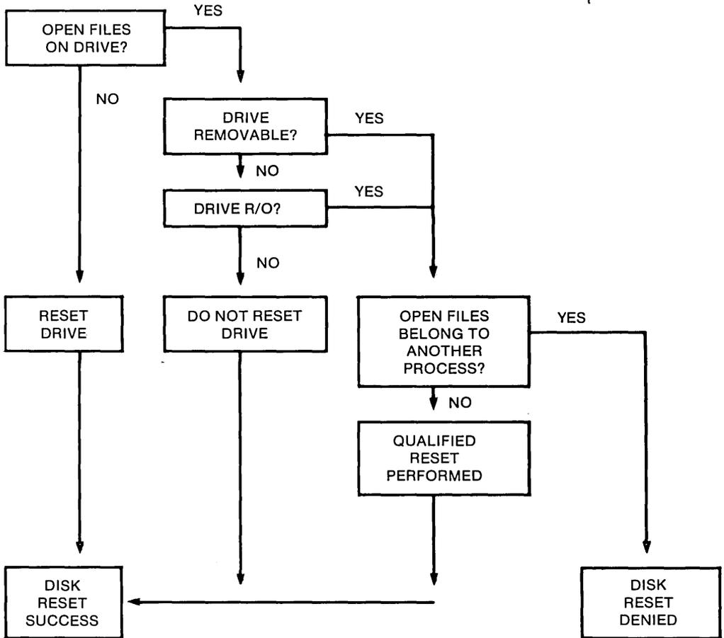
Figure 2-6. Disk System Reset
