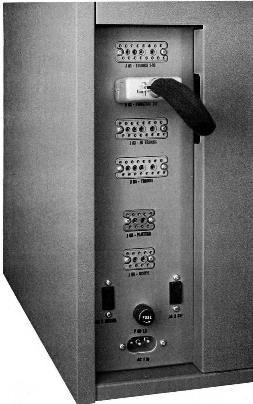
FIGURE 1.5-1 PLUG PLATE, REAR TR-48
