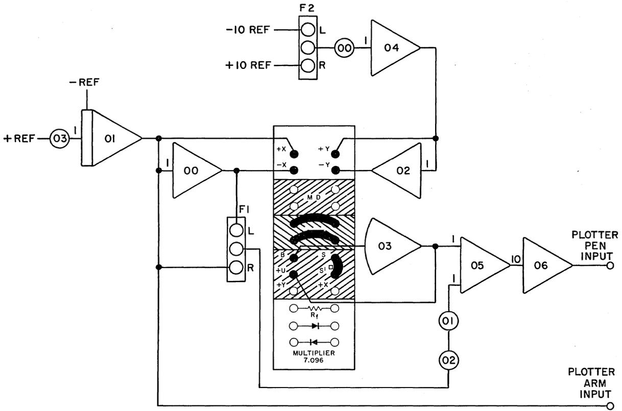
a. TEST SETUP SHOWING MULTIPLIER PATCH BLOCK
