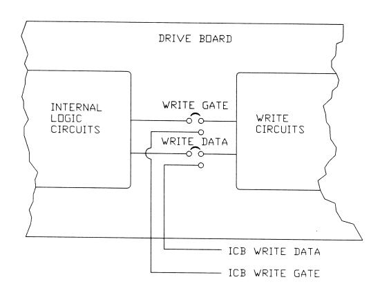
FIG. 7.3: WRITE SIGNAL CONNECTION (JUMPERS)
