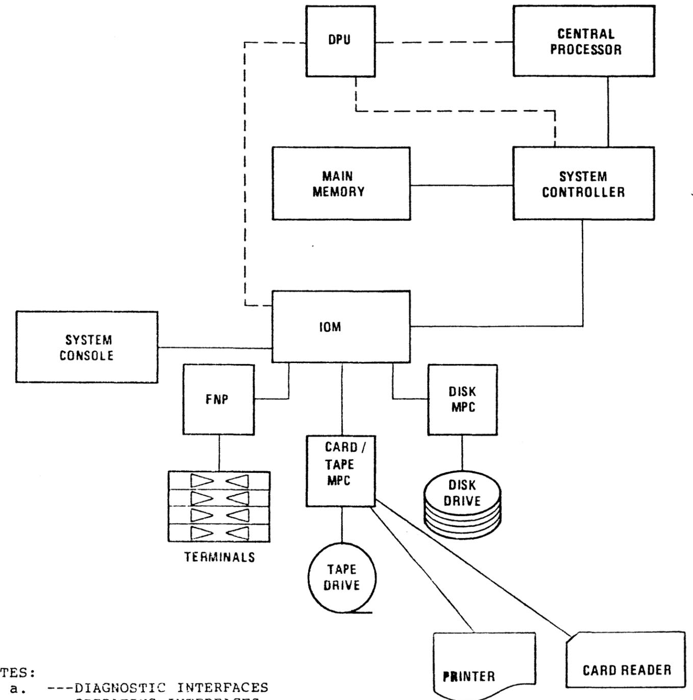
FIGURE 1-2. SYSTEM COMPONENTS
