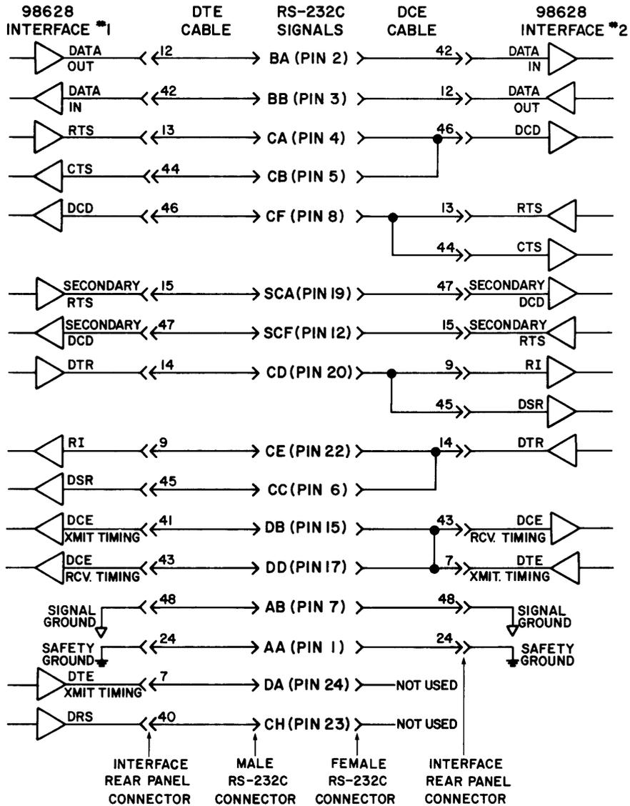
DTE/DCE Interface Cable Wiring
