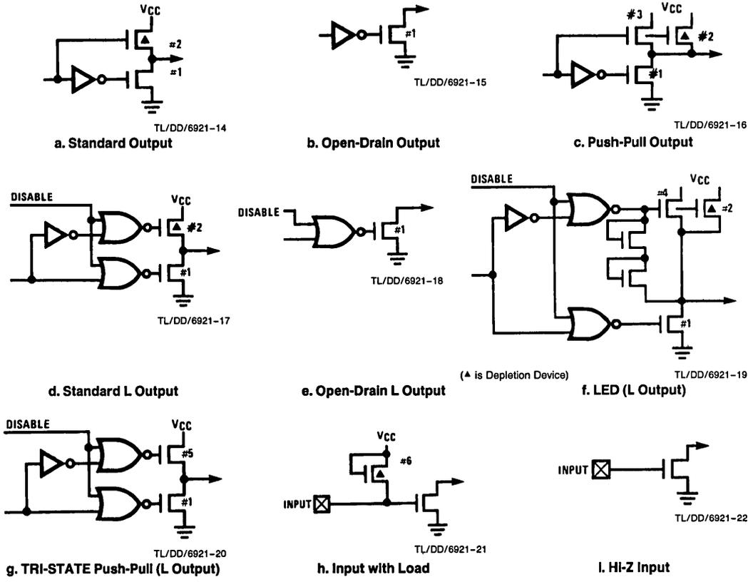
FIGURE 9a. Input/Output Configurations
