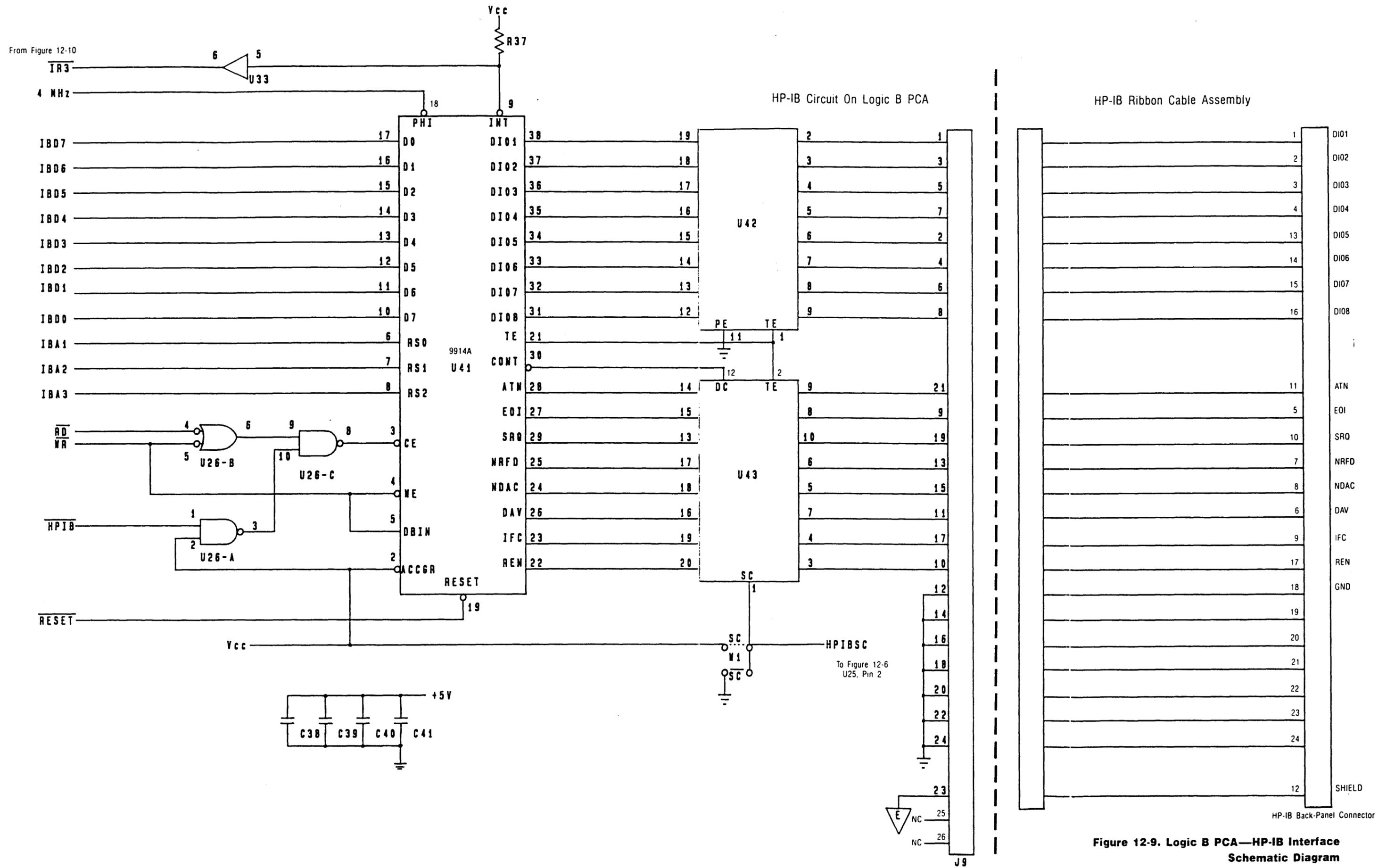
Figure 12-9. Logic B PCA—HP-IB Interface Schematic Diagram
