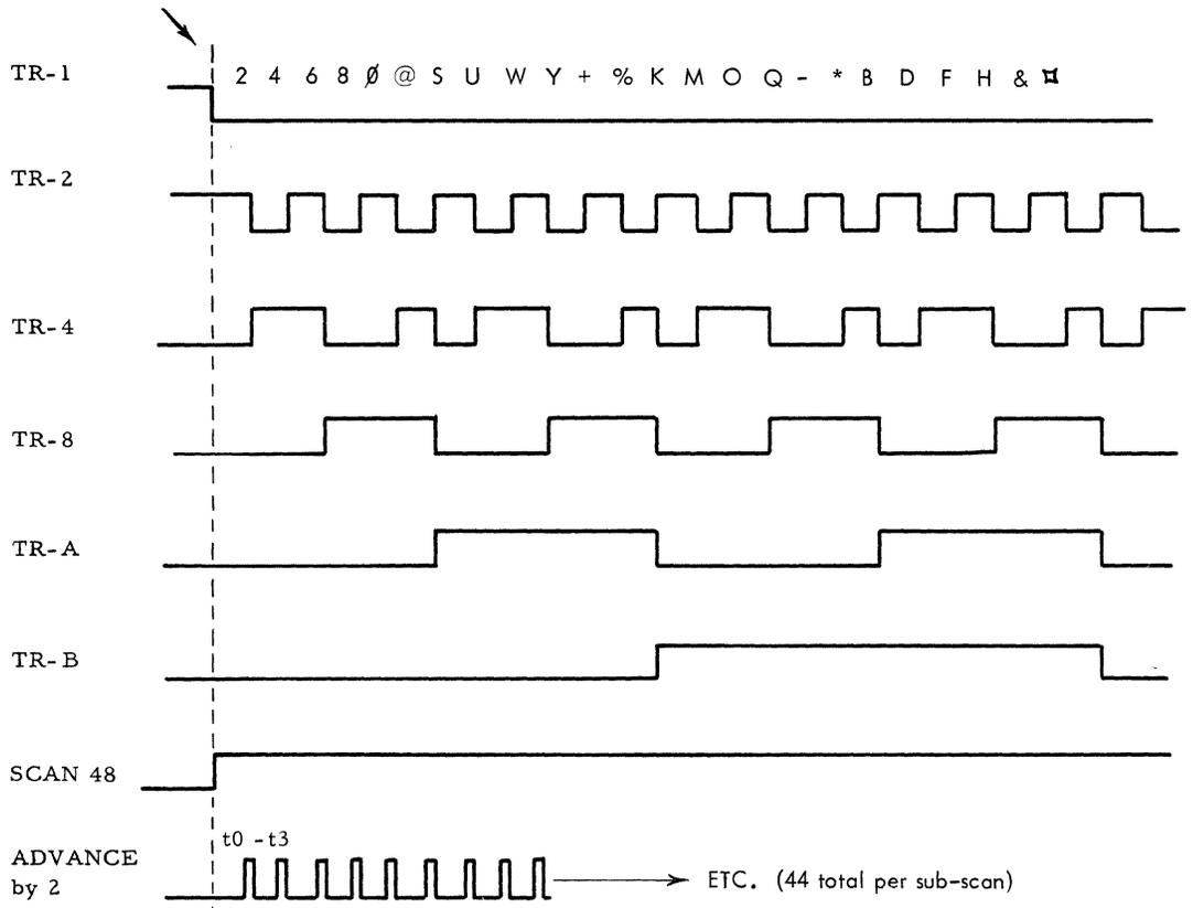
I. JUMPER TO ALLOW PRINTING TO BEGIN ONLY WITH THE PSS PULSE FOLLOWING THE HOME PULSE. SYNC. ON +U SCAN 48 GOING POSITIVE AND PRINT. TRIGGER 1 SHOULD TURN "OFF" WITH THE FIRST PSS PULSE AND THE PATTERN SHOULD BE AS SHOWN ABOVE. EACH DIVISION IS A CLOCK CYCLE. (11.1 MICROSECONDS)
