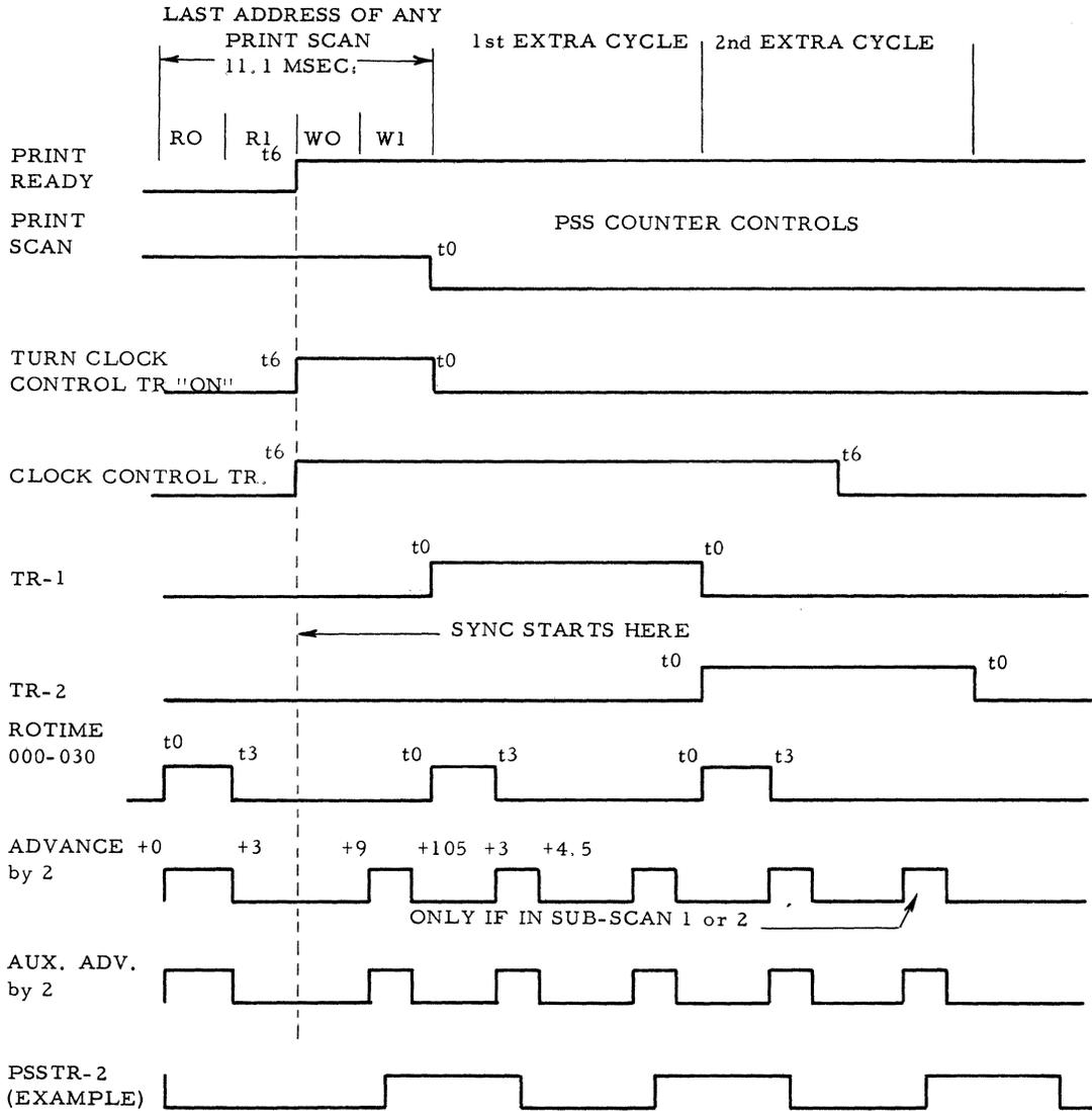
1. SYNC. ON CLOCK CONTROL TRIGGER GOING POSITIVE AND PRINT. PATTERN SHOULD BE AS SHOWN ABOVE.
