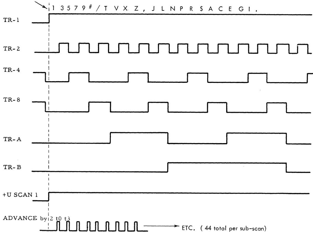
I. JUMPER (REFER TO S.H. 58) TO ALLOW PRINTING TO BEGIN ONLY WITH THE PSS PULSE FOLLOWING THE HOME PULSE. SYNC. ON +U SCAN 1 GOING POSITIVE AND PRINT. TRIGGER 1 SHOULD TURN "ON" WITH THE FIRST PSS PULSE AND THE PATTERN SHOULD BE AS SHOWN ABOVE. EACH DIVISION IS A CLOCK CYCLE. (11.1 MICROSECONDS)
