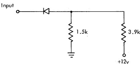
Figure 30. Tape Unit, Models 1-6, Metering-Out Line Termination
