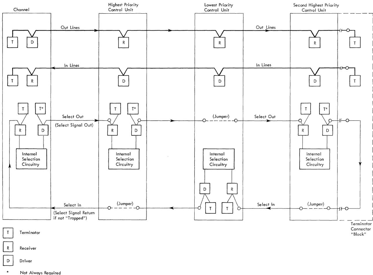
FIGURE 1-6. CONTROL UNIT PRIORITY WIRING
