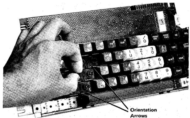
**Diagram 5-5. Switch Module Orientation**
