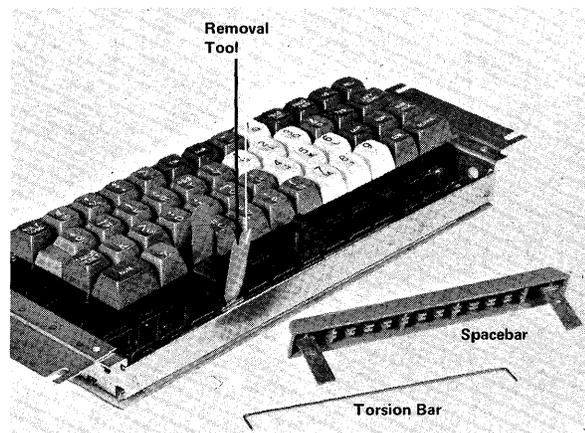
Diagram 5-7. Spacebar Guide Module Removal
