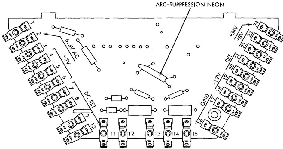
**Diagram 7-11. Model 2 Voltage Distribution Board**
