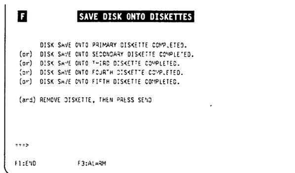
Figure 11-6. Save Disk Function Diskette Copy End Screen
