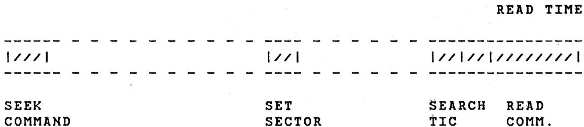
Fig. 4.2. MODES OF DISK/CHANNEL OPERATION.
