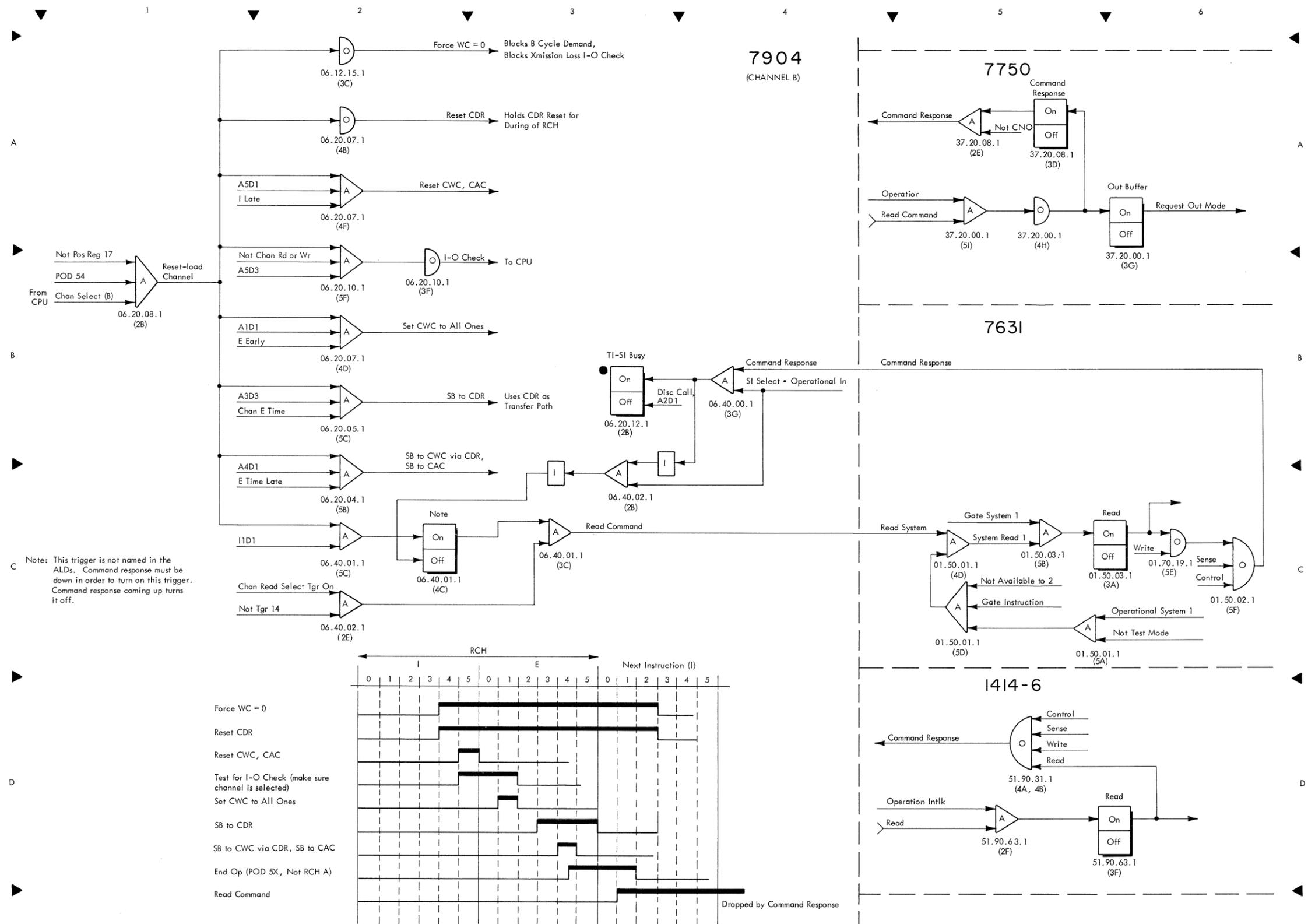
FIGURE 52. RCH, SIMPLEX INTERFACE READ OPERATION
