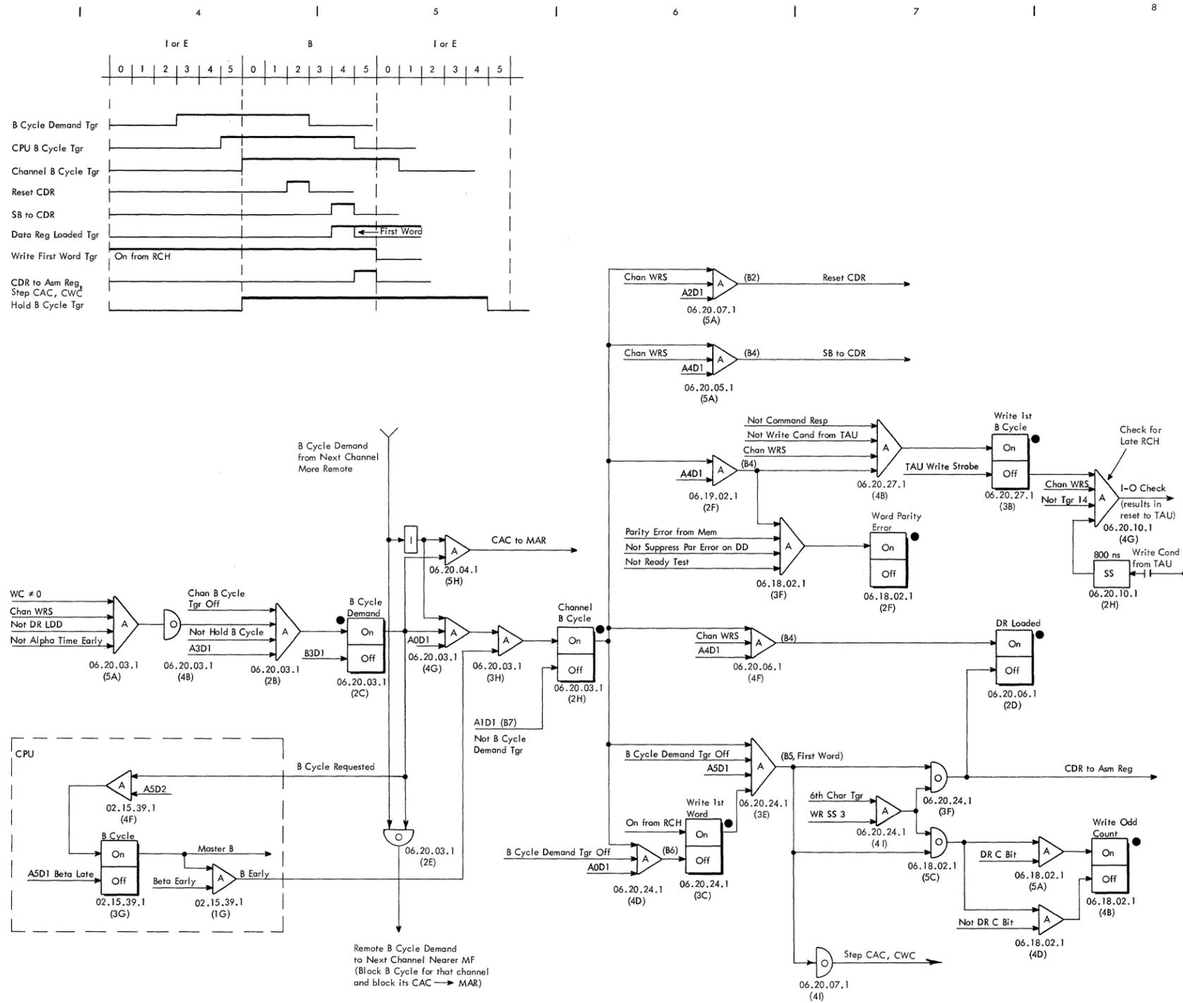
FIGURE 14. B CYCLE, WRITE TAPE OPERATION
