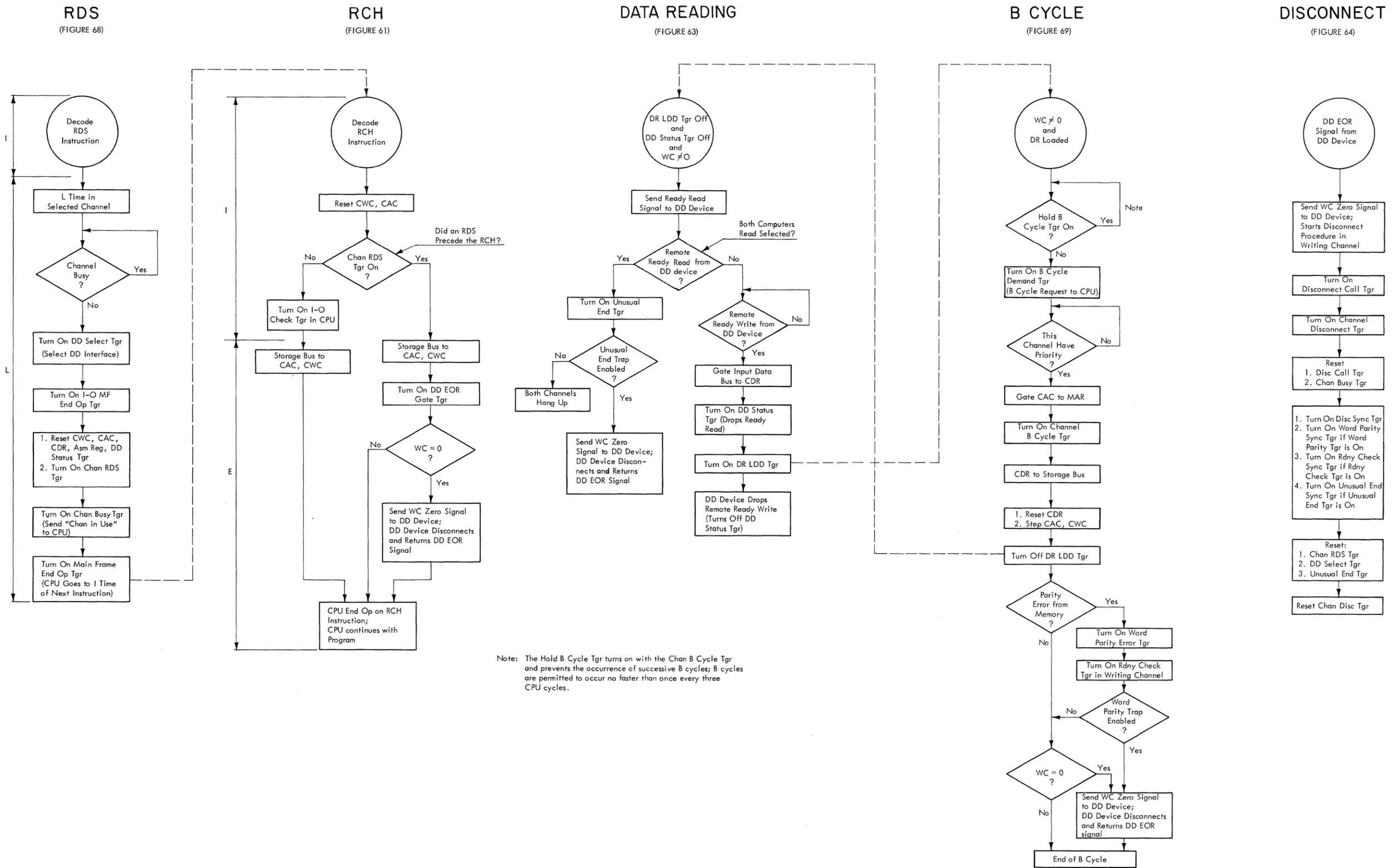
FIGURE 67. DIRECT DATA READ OPERATION SEQUENCE
