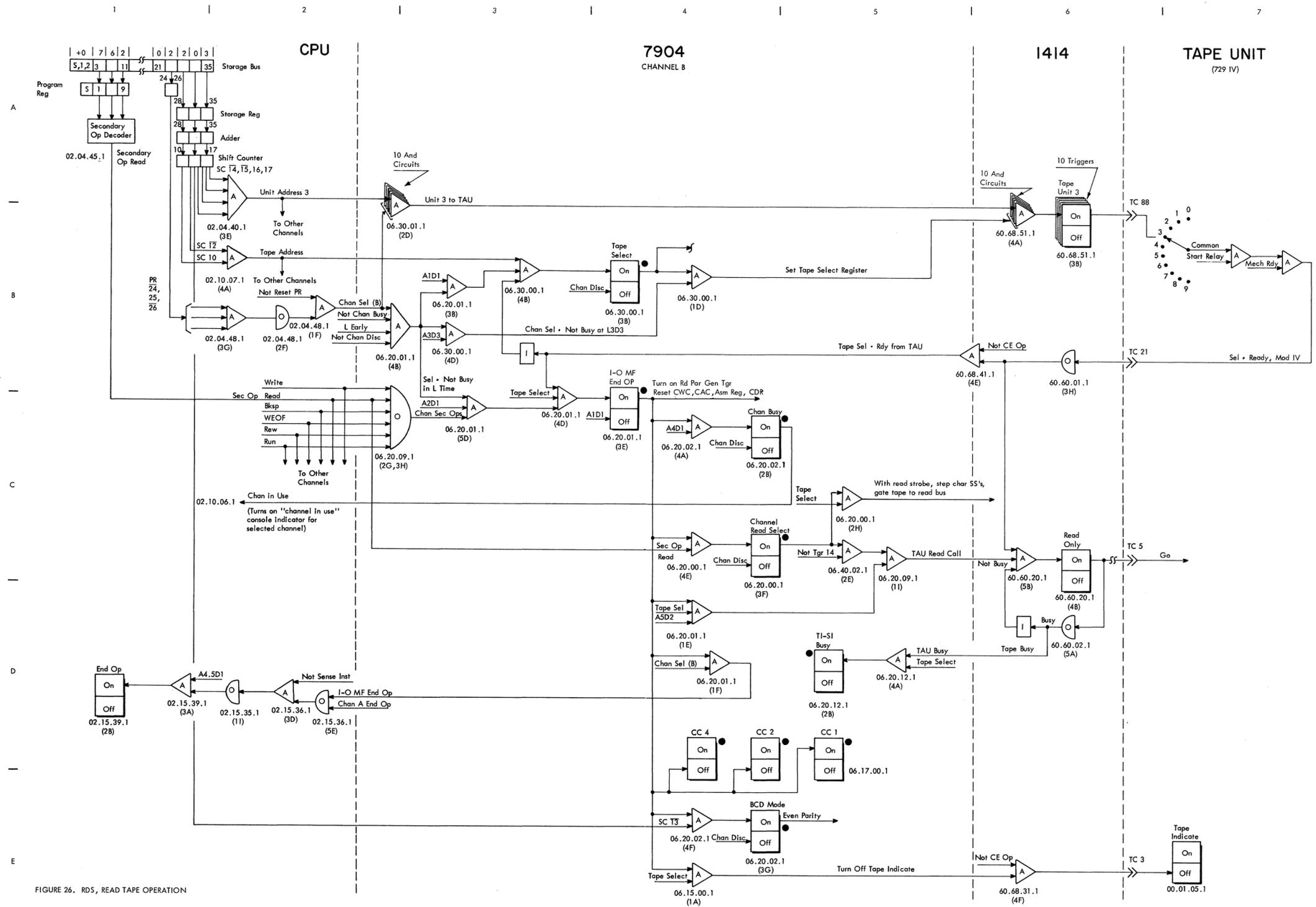
FIGURE 26. RDS, READ TAPE OPERATION
