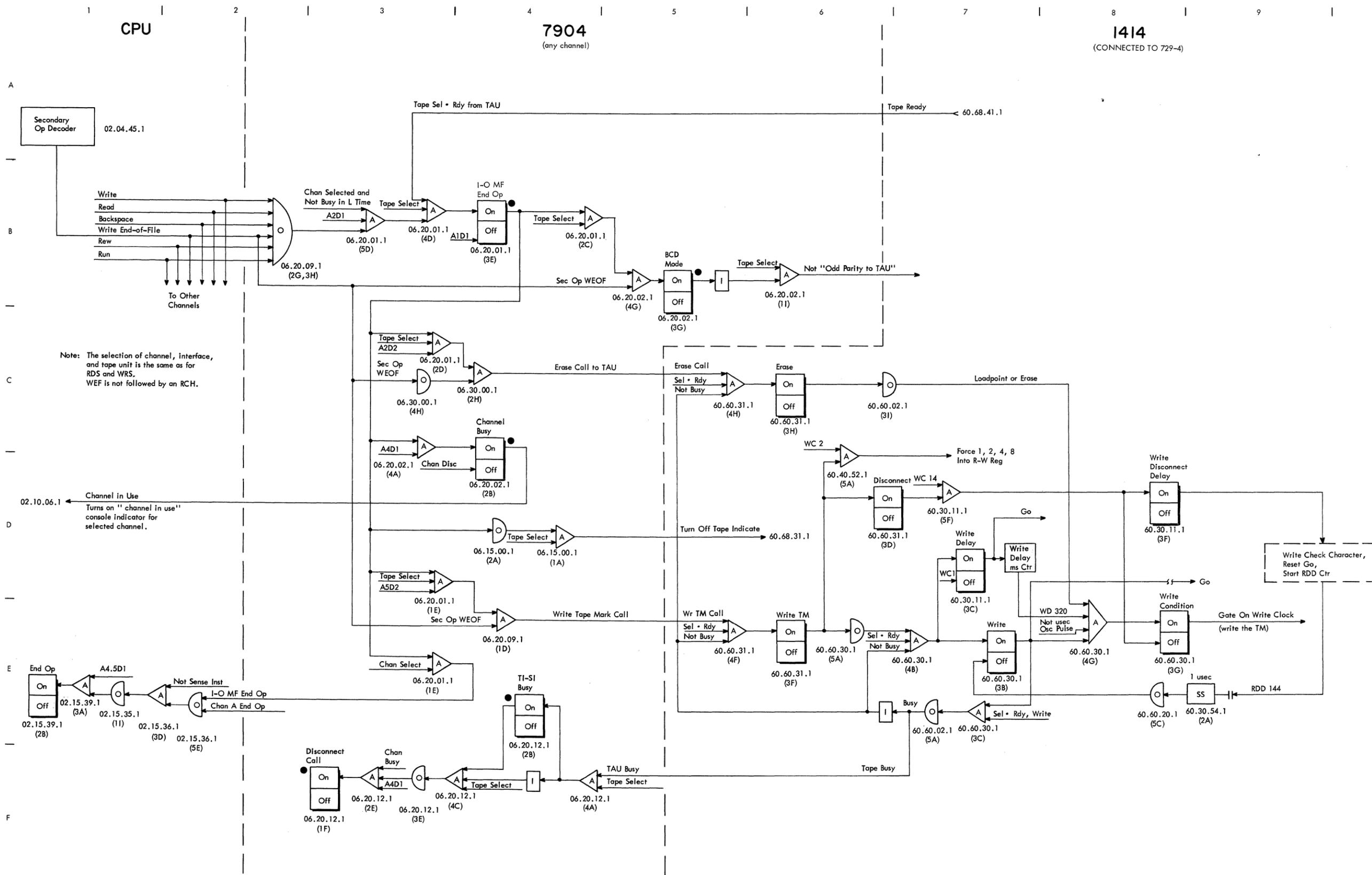
FIGURE 35. WEF, WRITE-END-OF-FILE OPERATION
