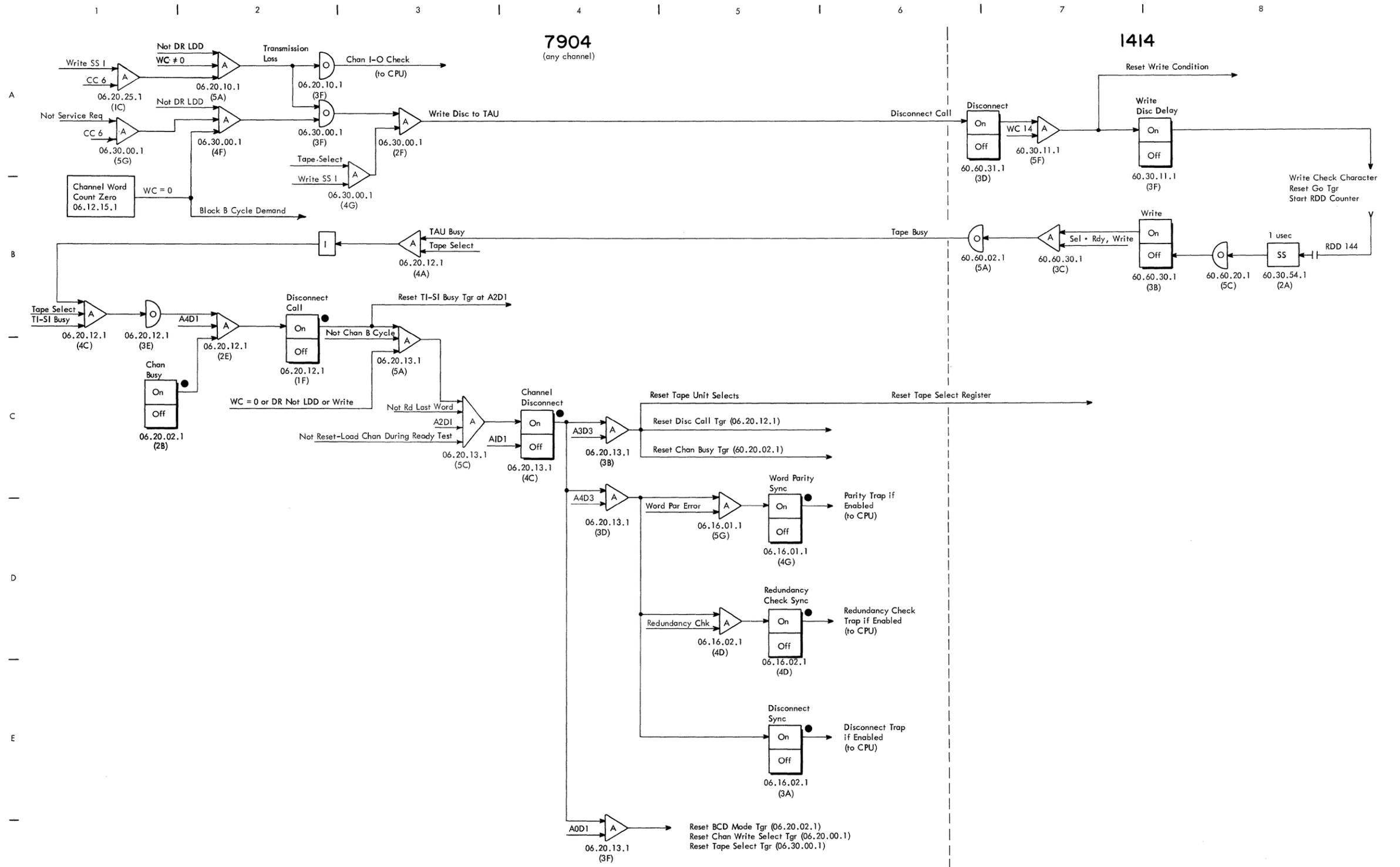
FIGURE 17. END OPERATION AND DISCONNECT, WRITE TAPE OPERATION
