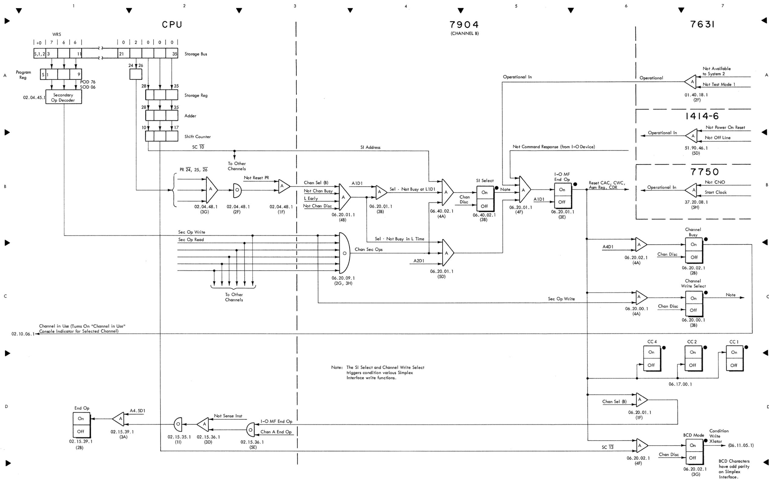
FIGURE 44. WRS, SIMPLEX INTERFACE WRITE OPERATION
