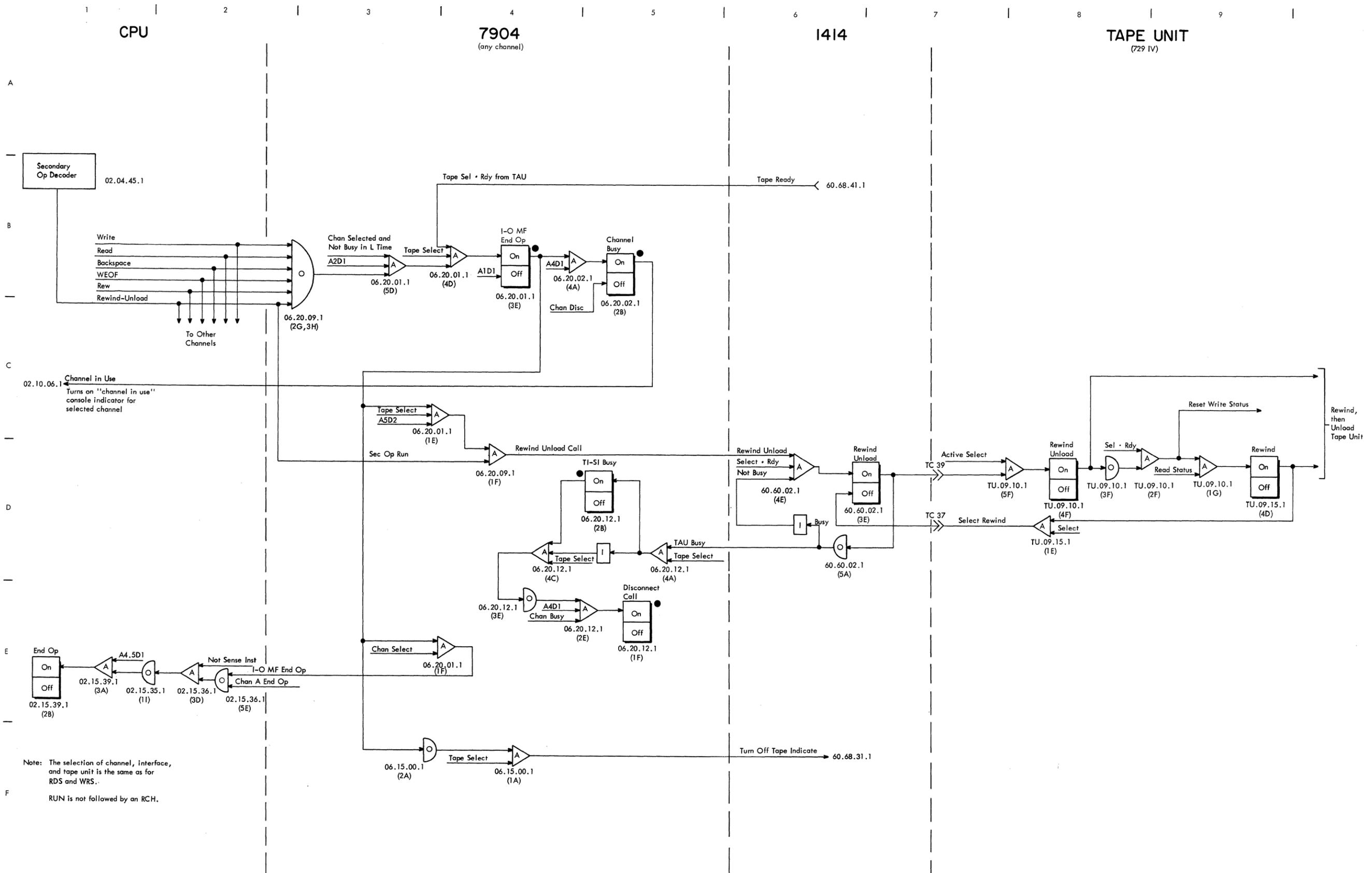
FIGURE 37. RUN, REWIND UNLOAD OPERATION
