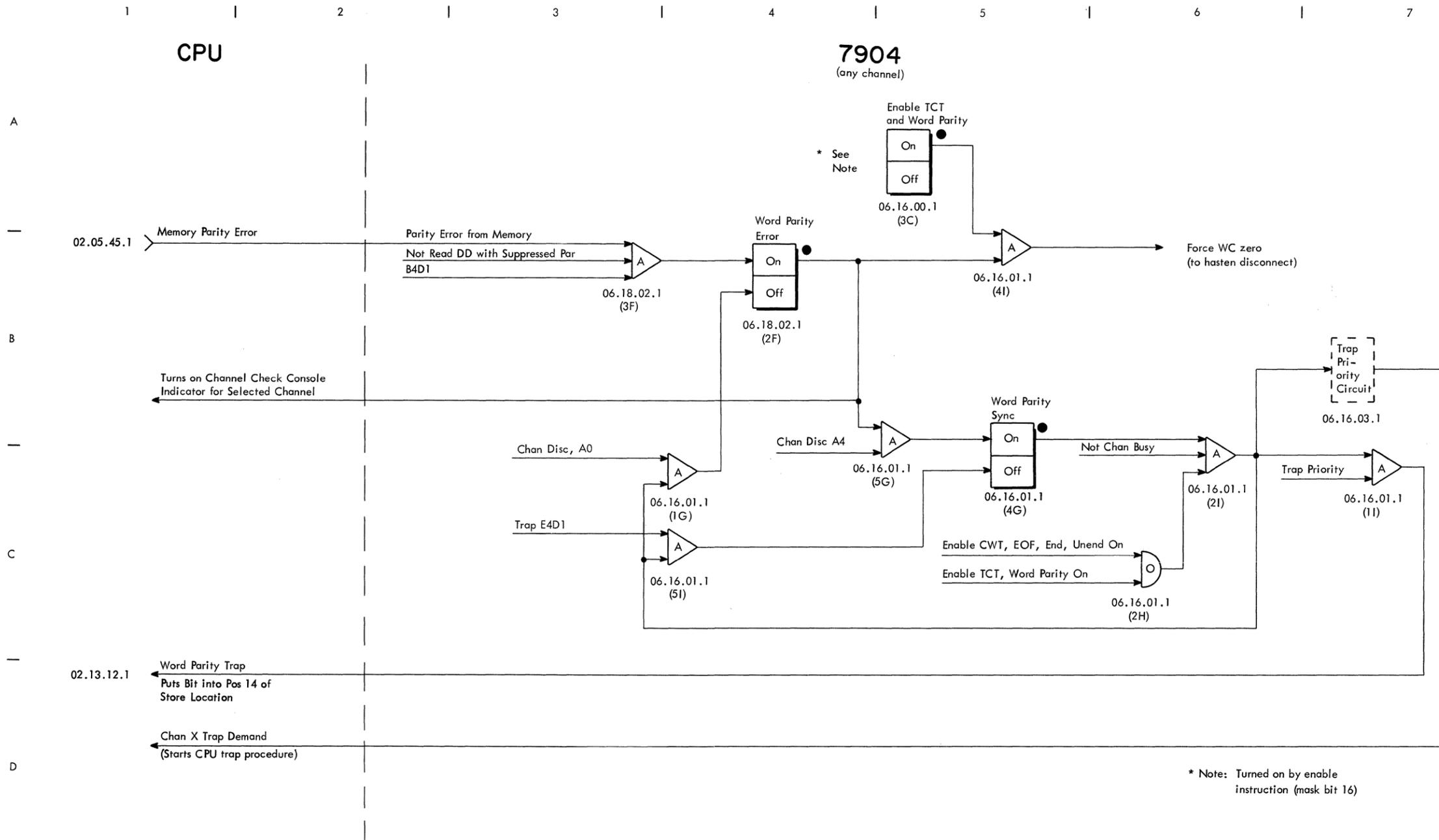
FIGURE 33. WORD PARITY ERROR, READ TAPE OPERATION
