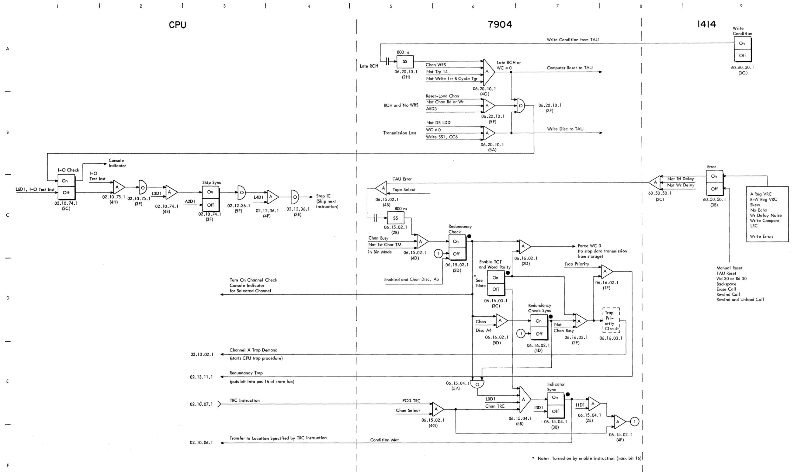
FIGURE 19. I-O CHECK AND REDUNDANCY CHECK, WRITE TAPE OPERATION
