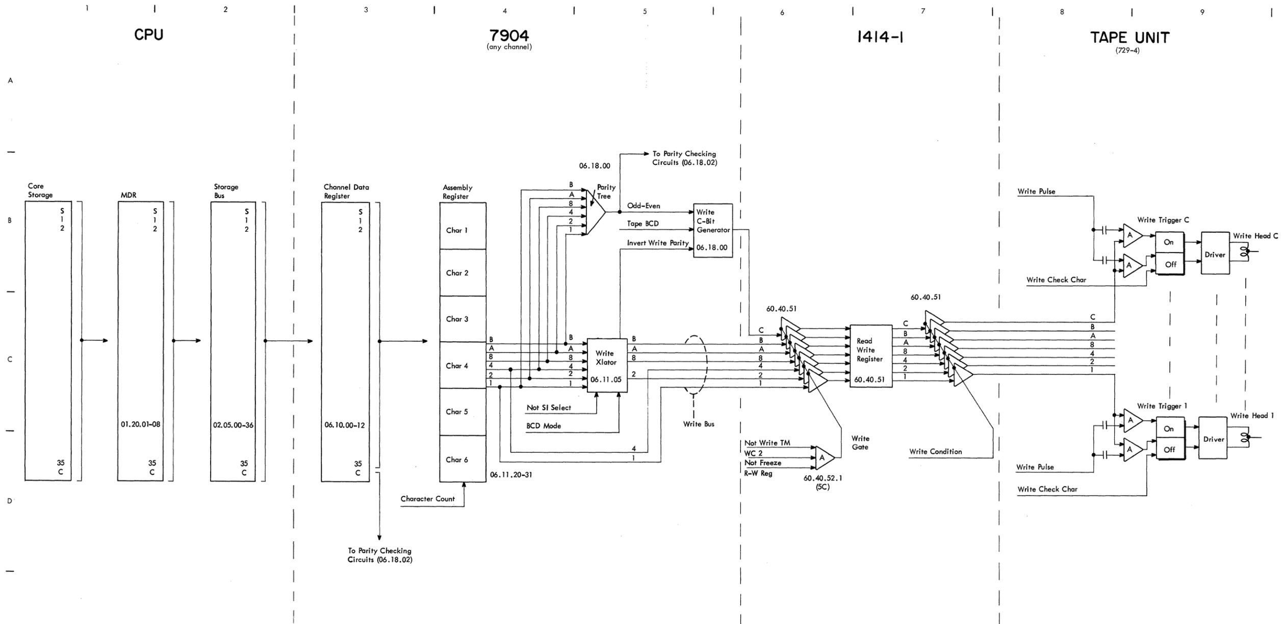
FIGURE 18. DATA FLOW, WRITE TAPE OPERATION
