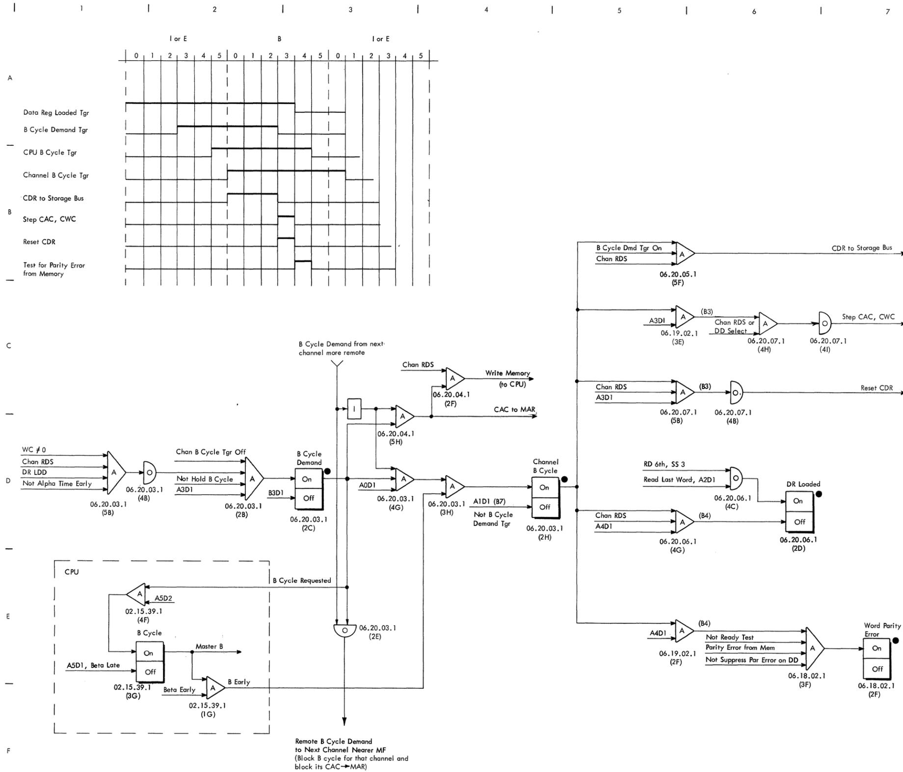
FIGURE 29. B CYCLE, READ TAPE OPERATION
