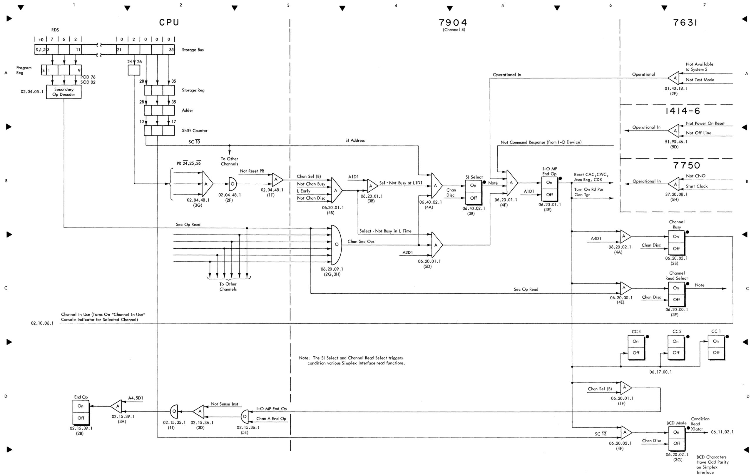
FIGURE 51. RDS, SIMPLEX INTERFACE READ OPERATION
