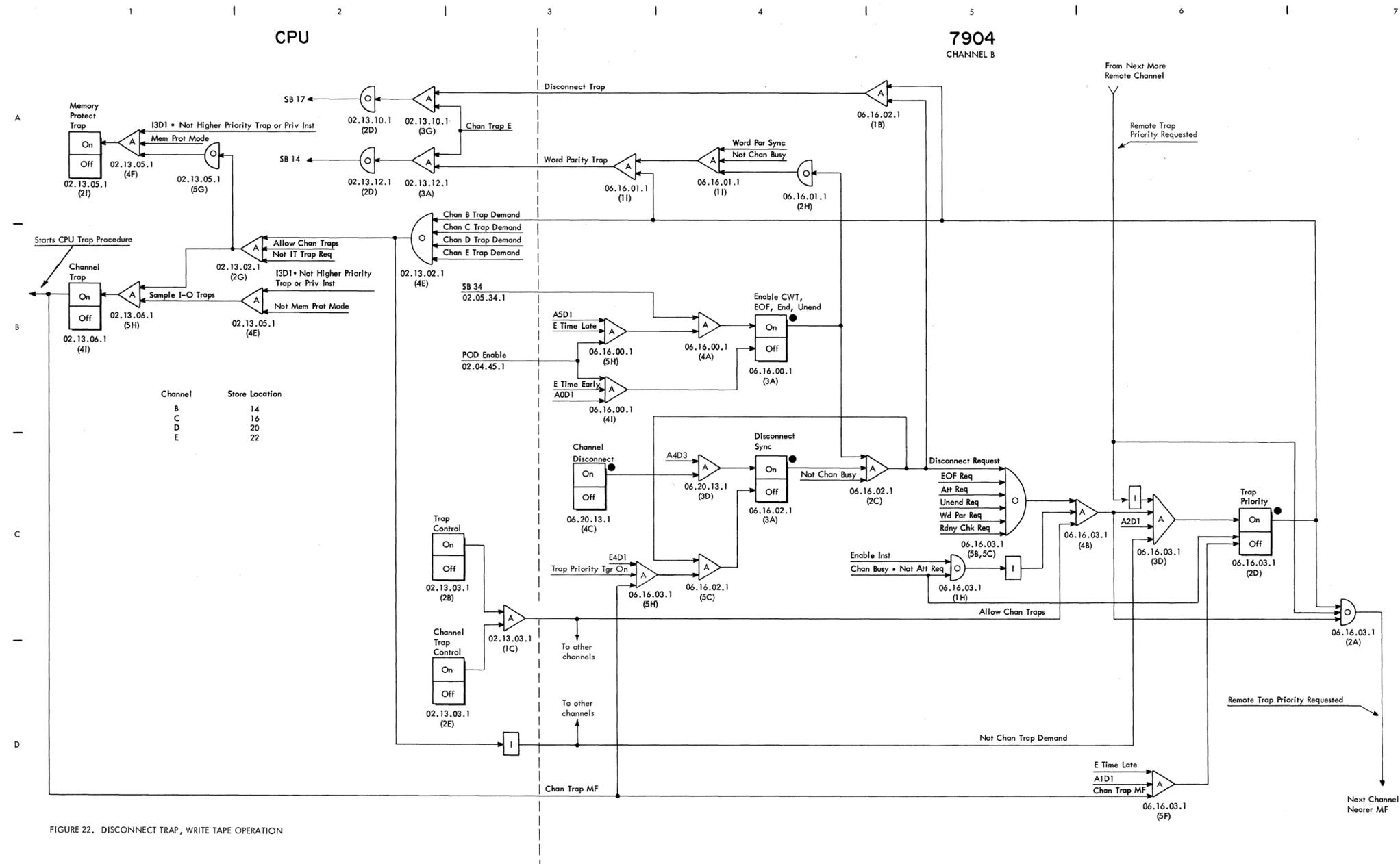
FIGURE 22. DISCONNECT TRAP, WRITE TAPE OPERATION
