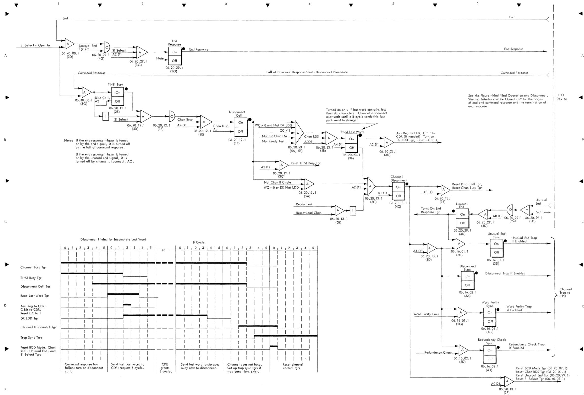
FIGURE 54. END OPERATION AND DISCONNECT, SIMPLEX INTERFACE READ OPERATION
