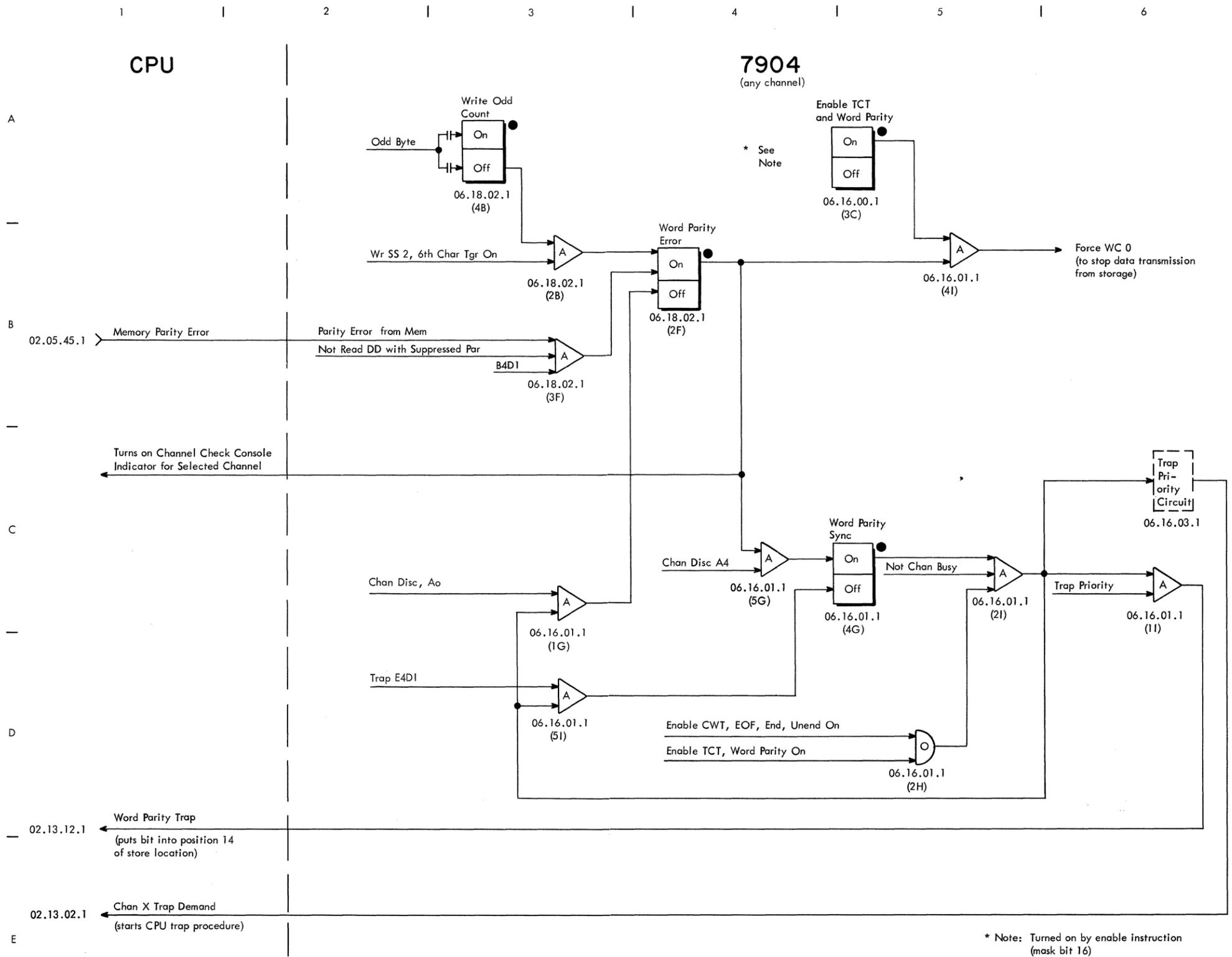
FIGURE 20. WORD PARITY ERROR, WRITE TAPE OPERATION
