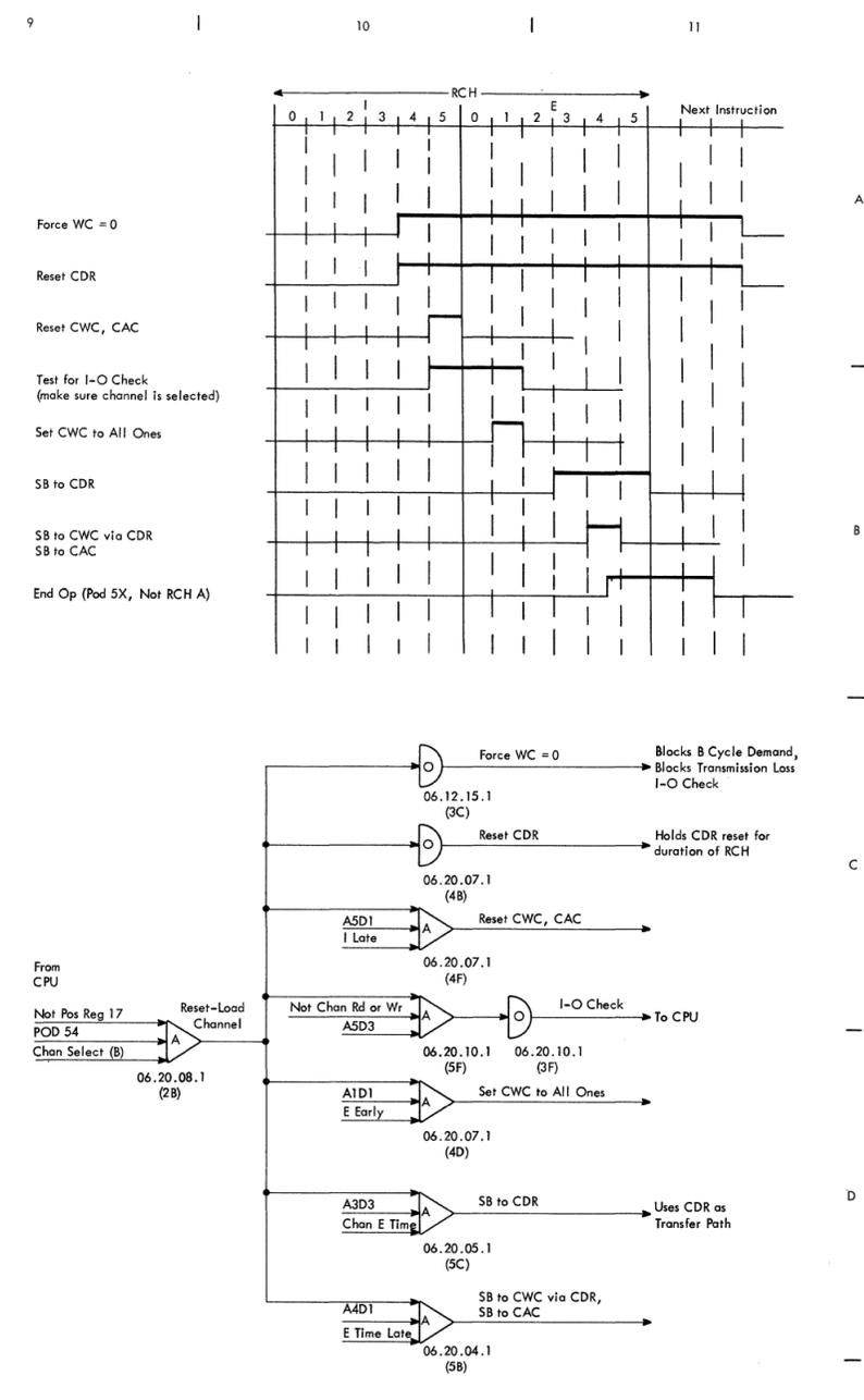
FIGURE 27. RCH, READ TAPE OPERATION
