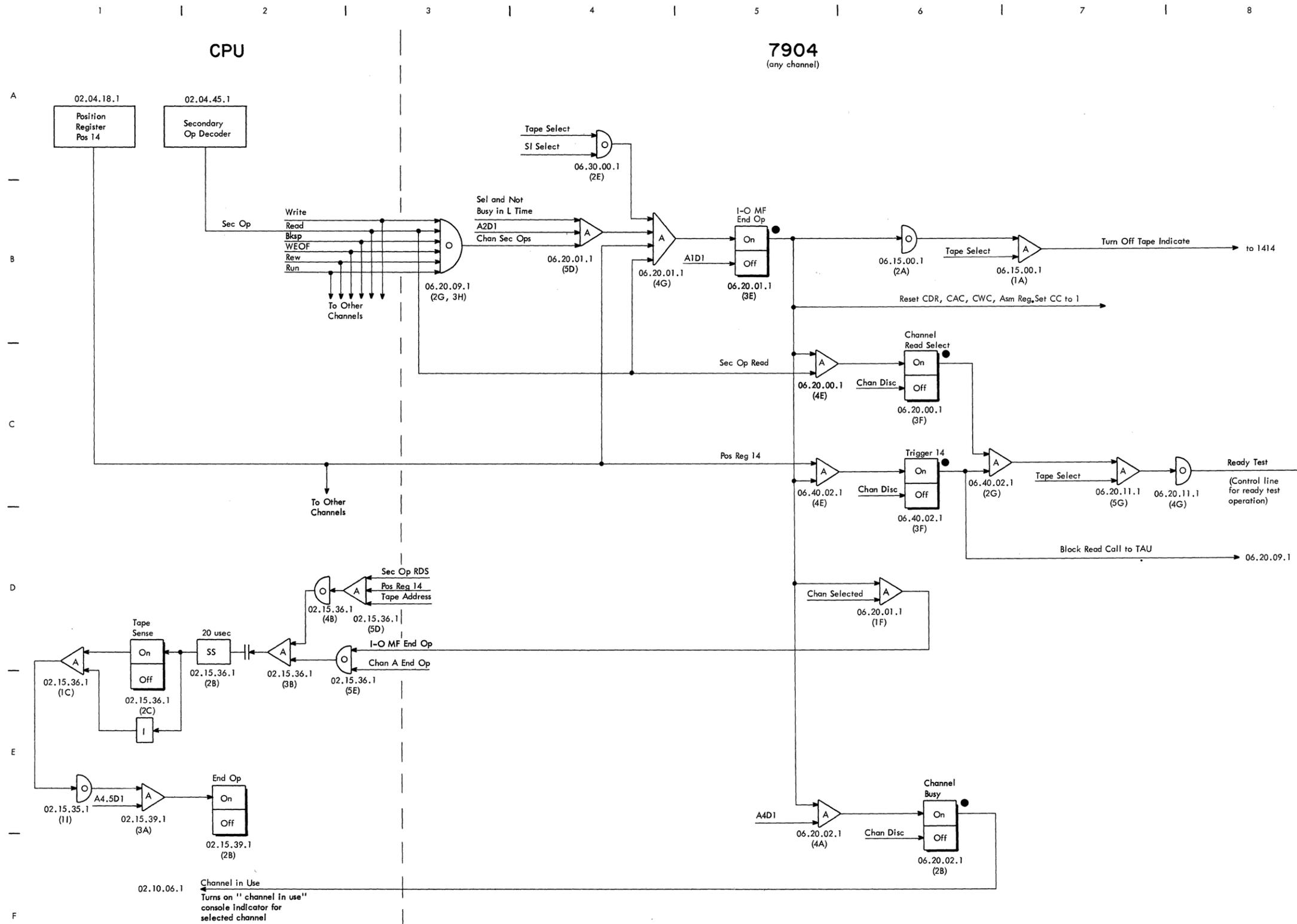
FIGURE 39. SEN, TAPE READY TEST OPERATION
