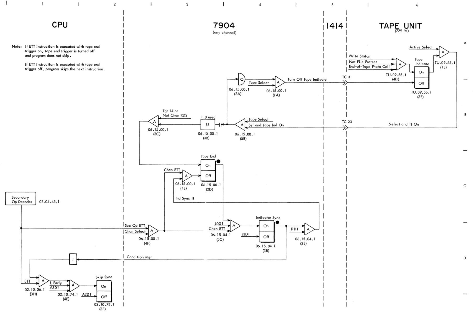
FIGURE 21. ETT, END-OF-TAPE OPERATION
