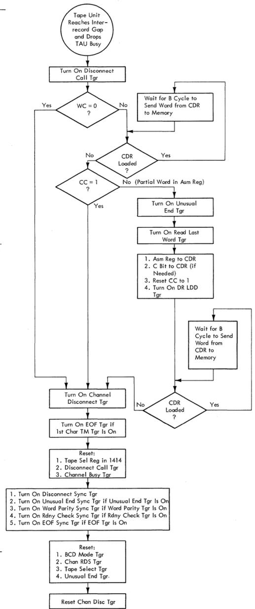
FIGURE 25. READ TAPE OPERATION SEQUENCE
