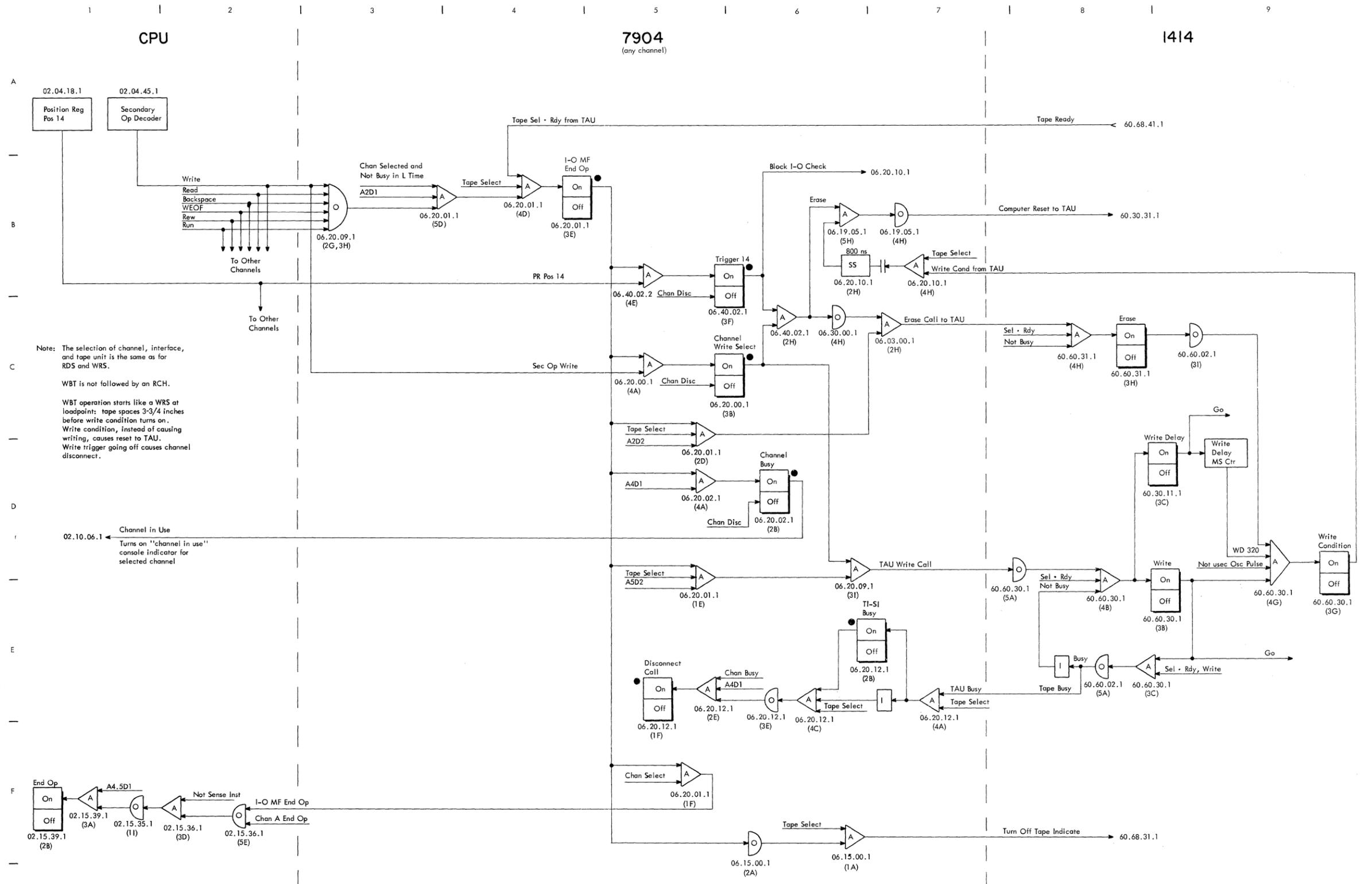
FIGURE 38. WBT, WRITE BLANK TAPE OPERATION
