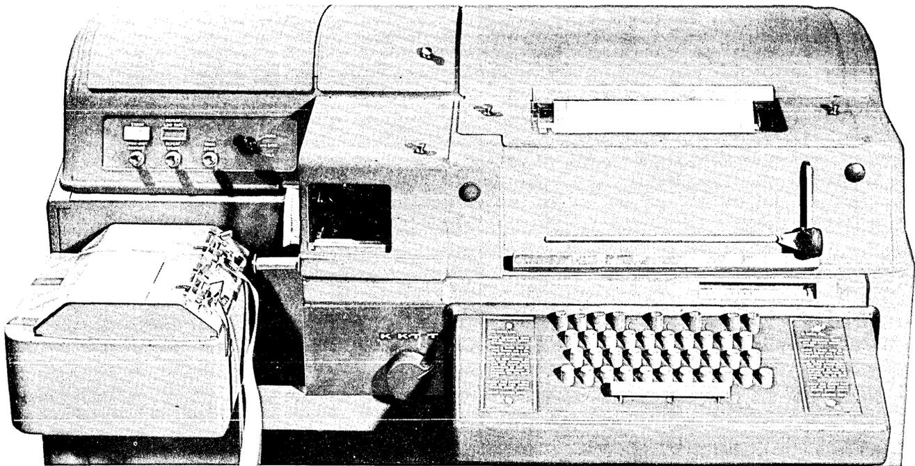
FIGURE 1-25. AUTOMATIC SEND RECEIVE MODEL 28, ASR 28
