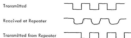
FIGURE 1-17. TELEGRAPH REGENERATIVE REPEATER WAVEFORMS
