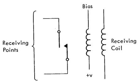
FIGURE 1-7. POLAR RELAY CIRCUIT
