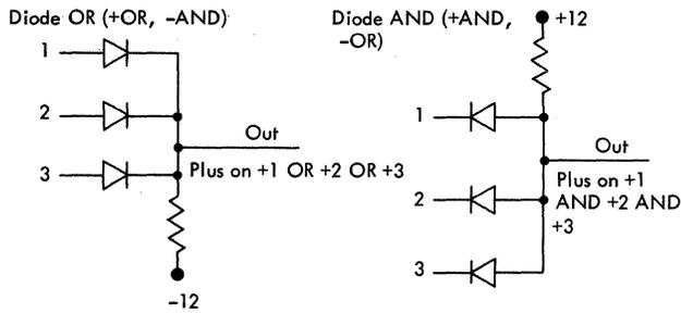
Figure 10. DDTL Diode Circuits
