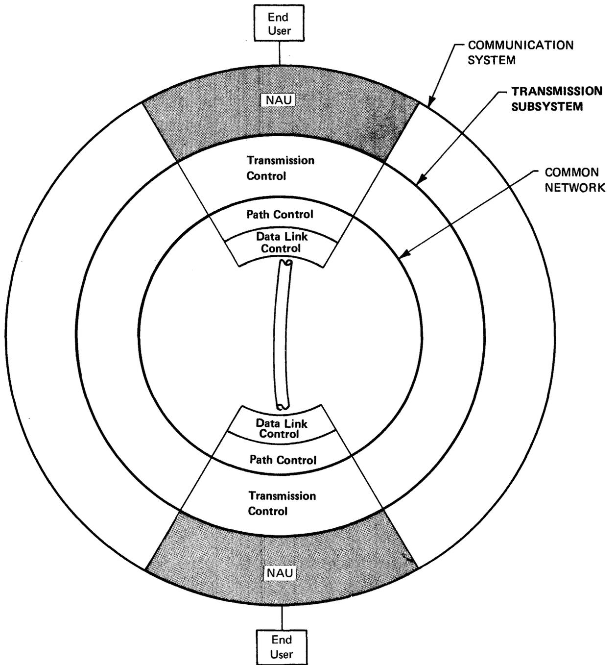
Figure 2-4. Transmission Subsystem
