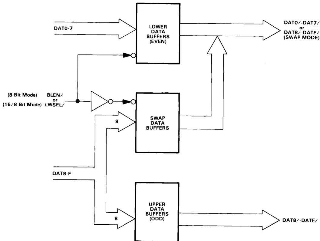
Figure 3-4. Byte Swap Block Diagram
