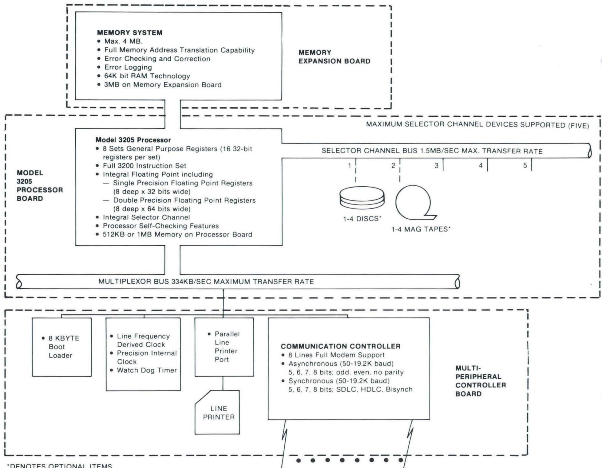
FIGURE 1. MODEL 3205 BLOCK DIAGRAM
