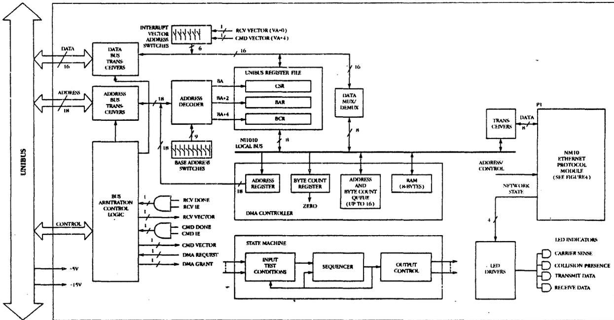
Figure 4-1. NI1010A UIB Block Diagram
