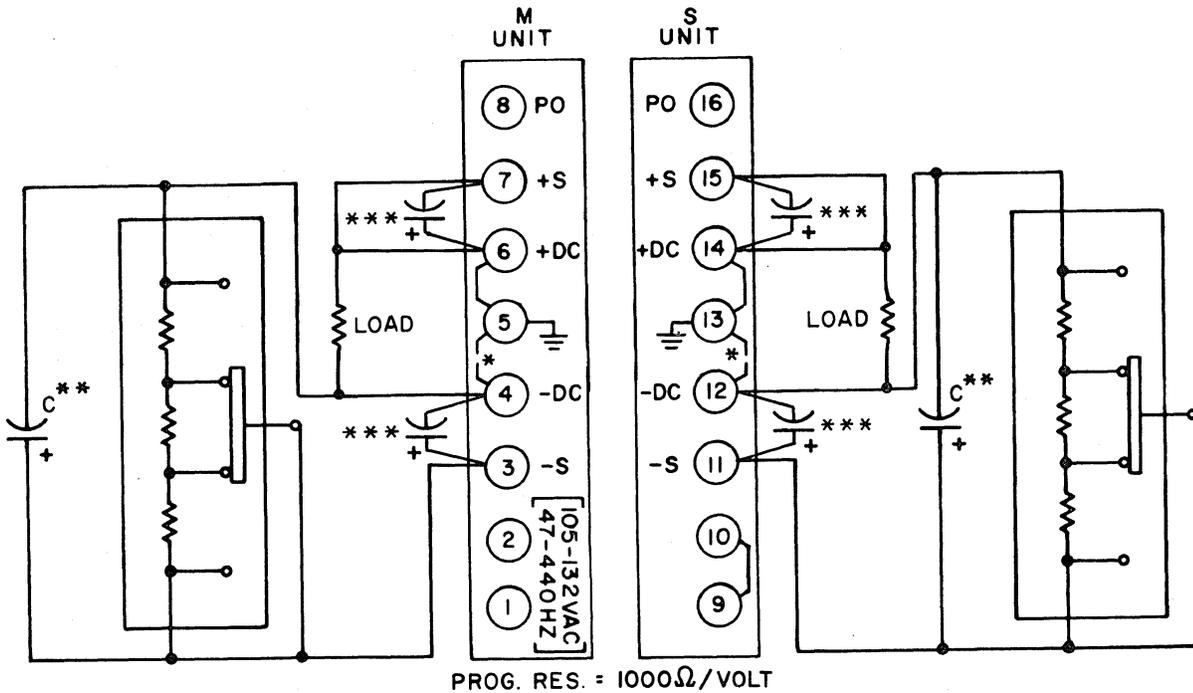
\*FOR NEGATIVE GROUND DISCONNECT JUMPERS FROM TERMINALS 5-6,13-14 AND RECONNECT TO TERMINALS 5-4,12-13.
