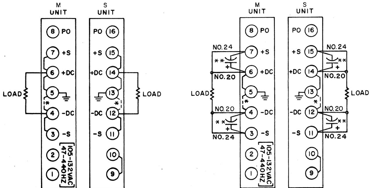
\* FOR NEGATIVE GROUND DISCONNECT JUMPERS FROM TERMINALS 5-6, 13-14 AND RECONNECT TO TERMINALS 5-4, 12-13.
