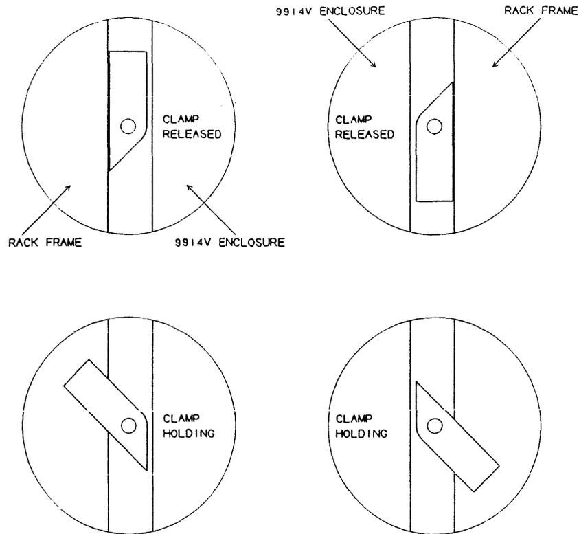
Figure 2.3.1.2 9914V RACK CLAMP DETAIL
