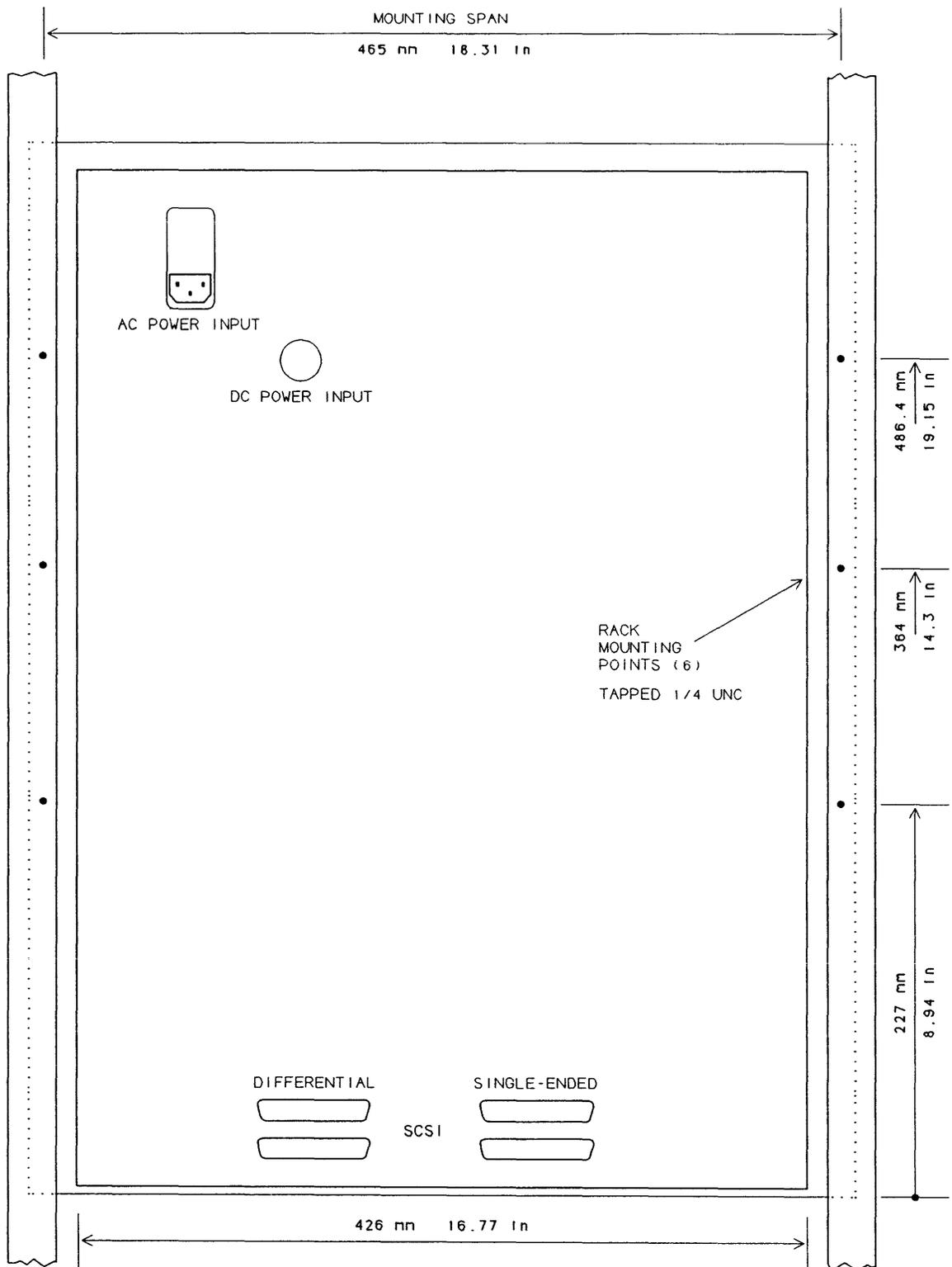
Figure 2.3.2.1 9914V RACK SCREW LOCATIONS
