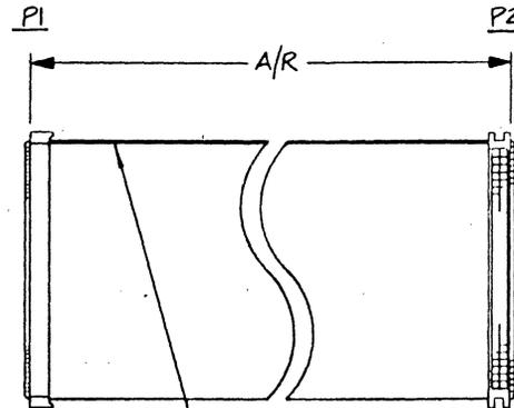
BE SURE TO NOTE THAT THIS EDGE OF STRAIN RELIEF IS SQUARE, OTHER SIDE IS ROUNDED
