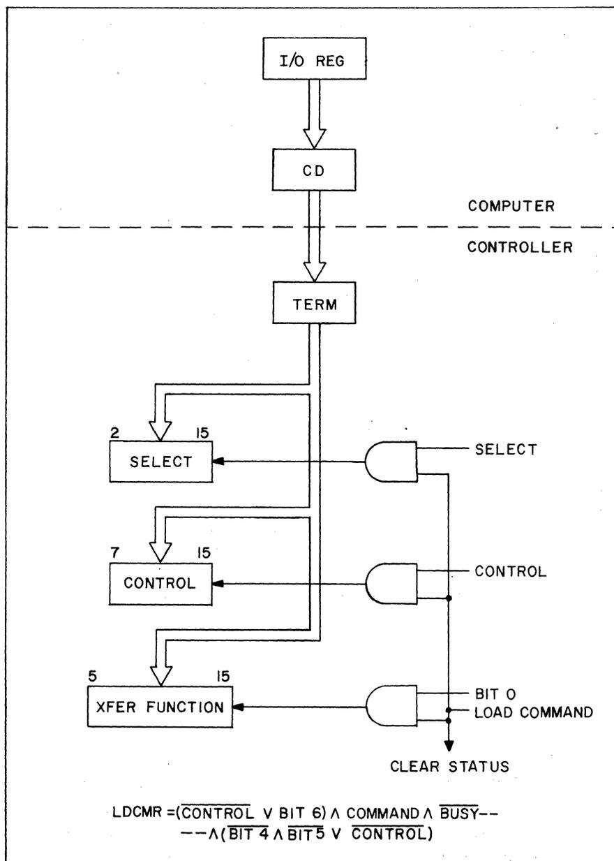
FIGURE 3-6 OUTPUT TO COMMAND REGISTER
