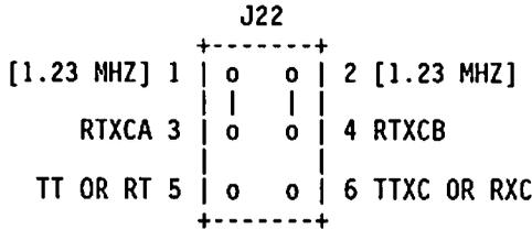
RTXCA PIN OF THE SCC IS DRIVEN BY ONBOARD 1.230769 MHZ. RTXCB IS DRIVEN BY ONBOARD 1.230769 MHZ. (FACTORY CONFIGURATION)
