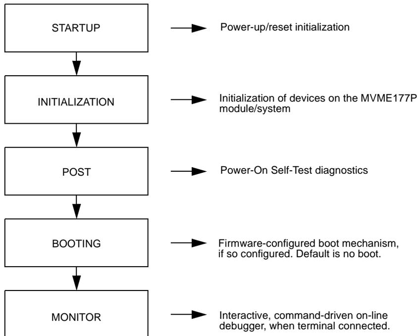
**Figure 2-1. MVME177P/Firmware System Startup**
