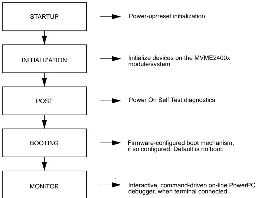
**Figure 2-1. SYSTEM BOOT-UP SEQUENCE**
