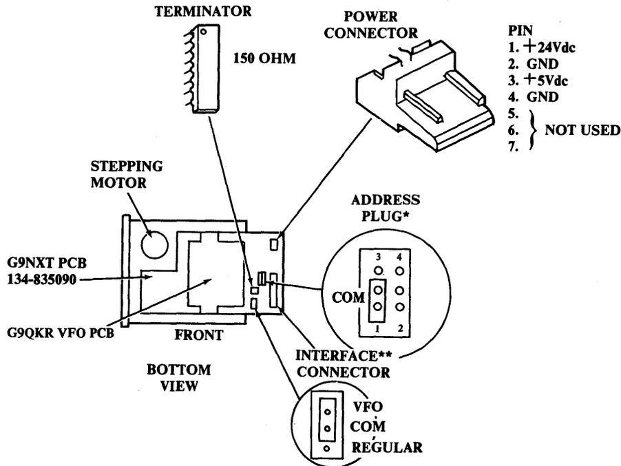
\* ADDRESS PLUG SET FOR MASTER (STAND-ALONE) DKU. SLAVE (EXPANSION) DKU-JUMPER PIN 2 TO COM (COMMON).
