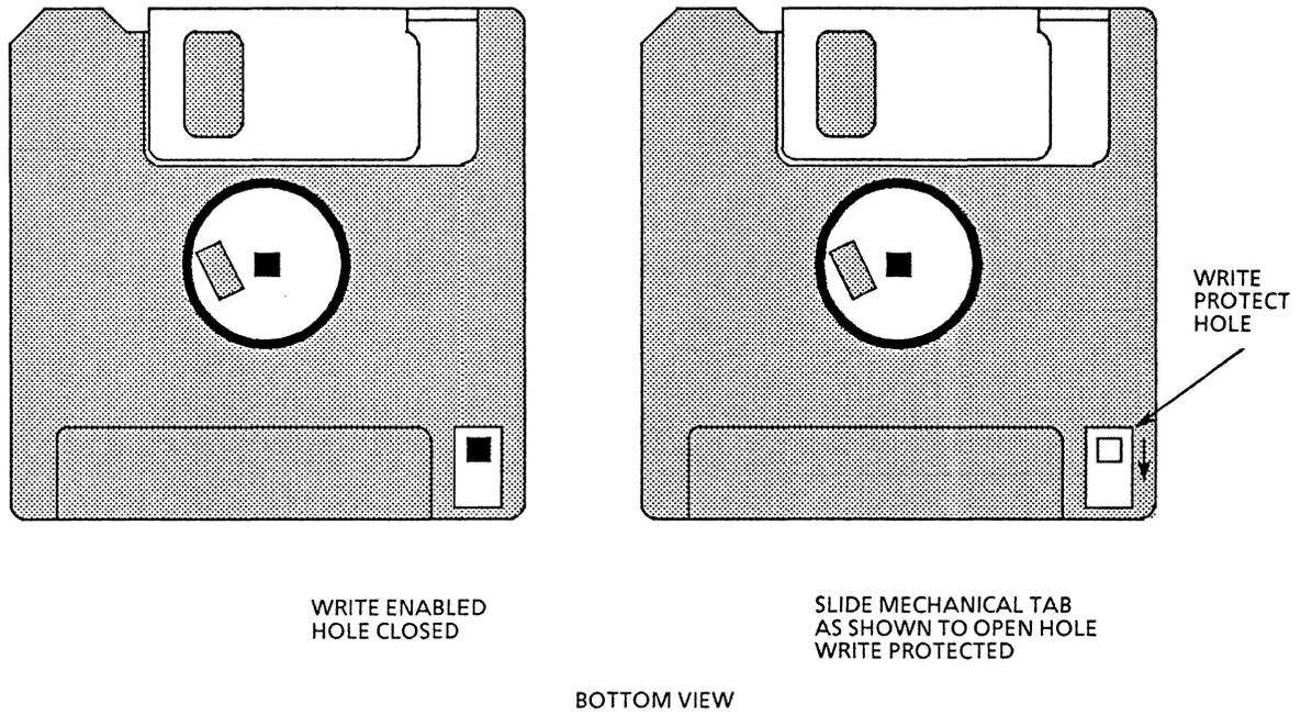
FIGURE 8-3 WRITE PROTECT OPERATION
