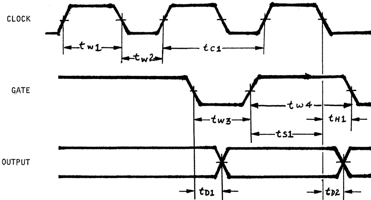
FIGURE 2-4: WAVEFORMS AT USER INTERFACE CONNECTOR J2
