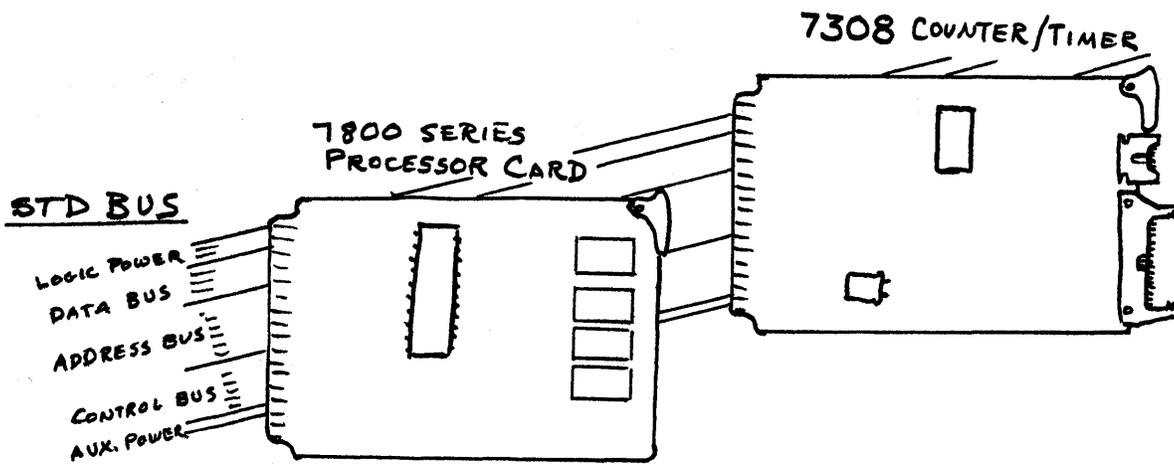
FIGURE 2-1: I/O MAPPED OPERATION IN LOCAL CARD RACK
