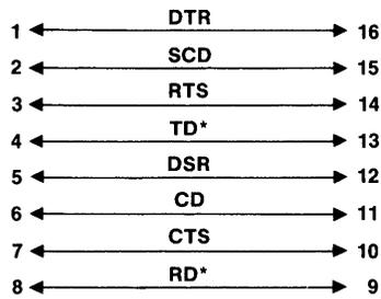
**Data Terminal/Data Set Select Plug P1 Wiring**
