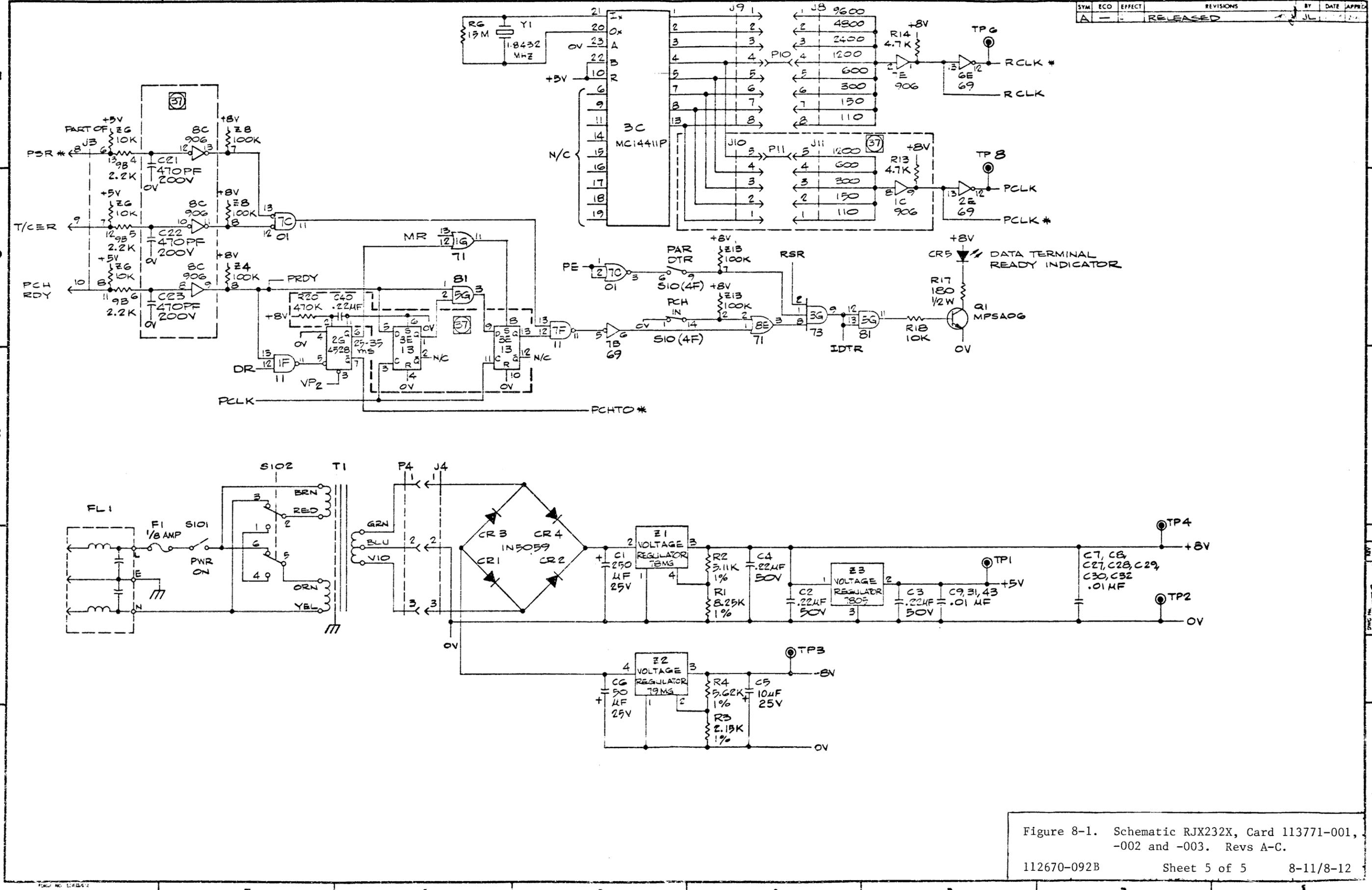
Figure 8-1. Schematic RJX232X, Card 113771-001, -002 and -003. Revs A-C.
