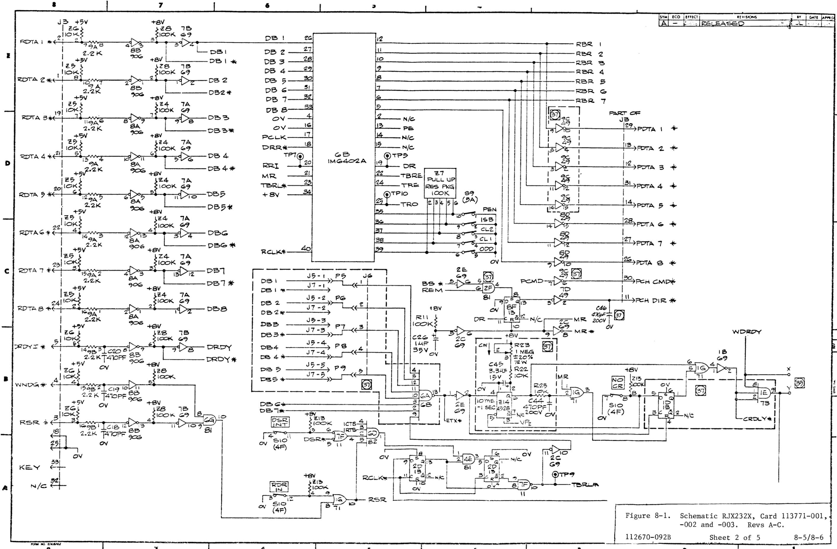
Figure 8-1. Schematic RJX232X, Card 113771-001, -002 and -003. Revs A-C.
