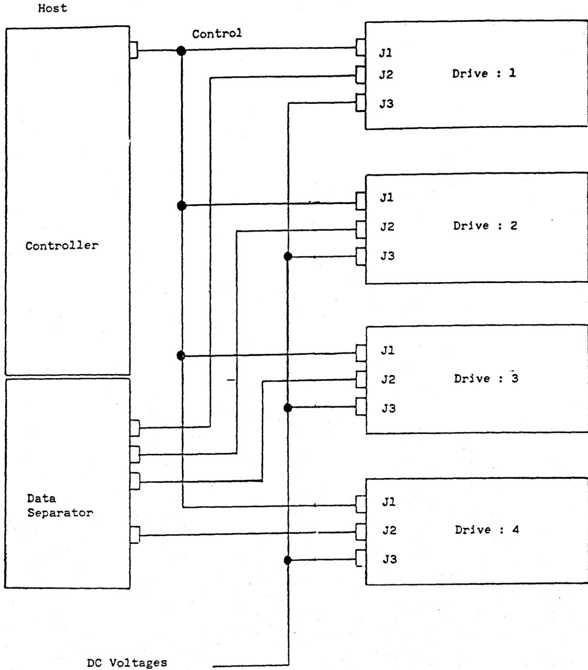
FIGURE 8 : SYSTEM WITH 4 DRIVES
