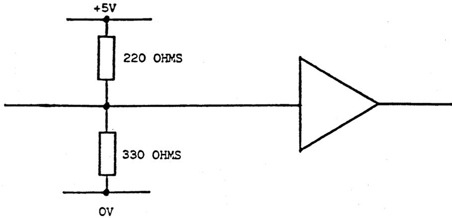
FIGURE 11 : CONTROL LINE TERMINATION
