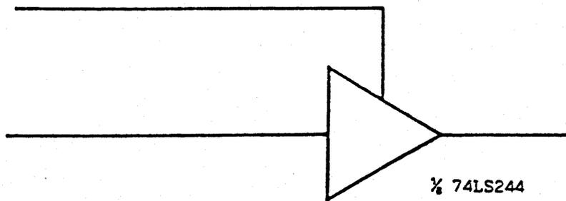
FIGURE 12 : TRI-STATE OUTPUT DRIVER
