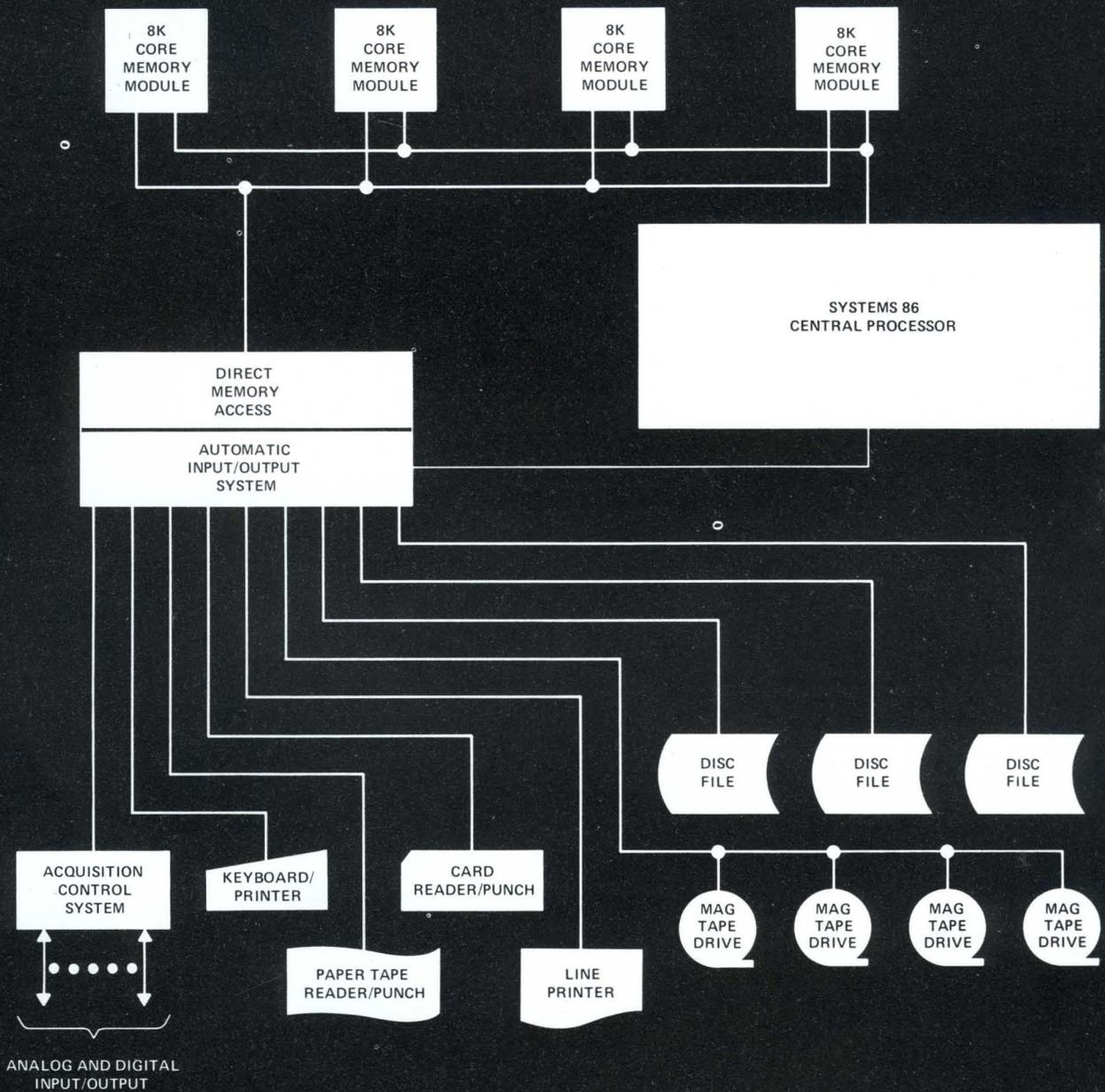
TYPICAL SYSTEMS 86 REAL-TIME CONTROL/BATCH PROCESSING CONFIGURATION
