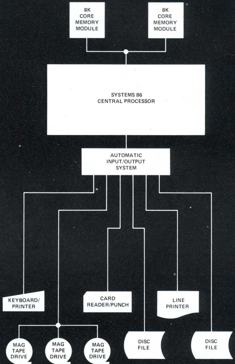
TYPICAL SYSTEMS 86 BATCH PROCESSING CONFIGURATION
