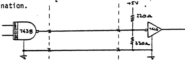
Figure 5. CONTROL SIGNAL DRIVER/RECEIVER COMBINATION
