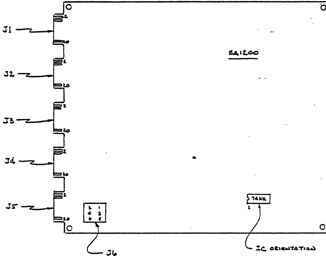
Figure 3. INTERFACE CONNECTOR PHYSICAL LOCATION
