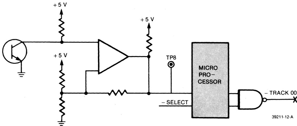
**FIGURE 2-3. TRACK ZERO CIRCUIT**
