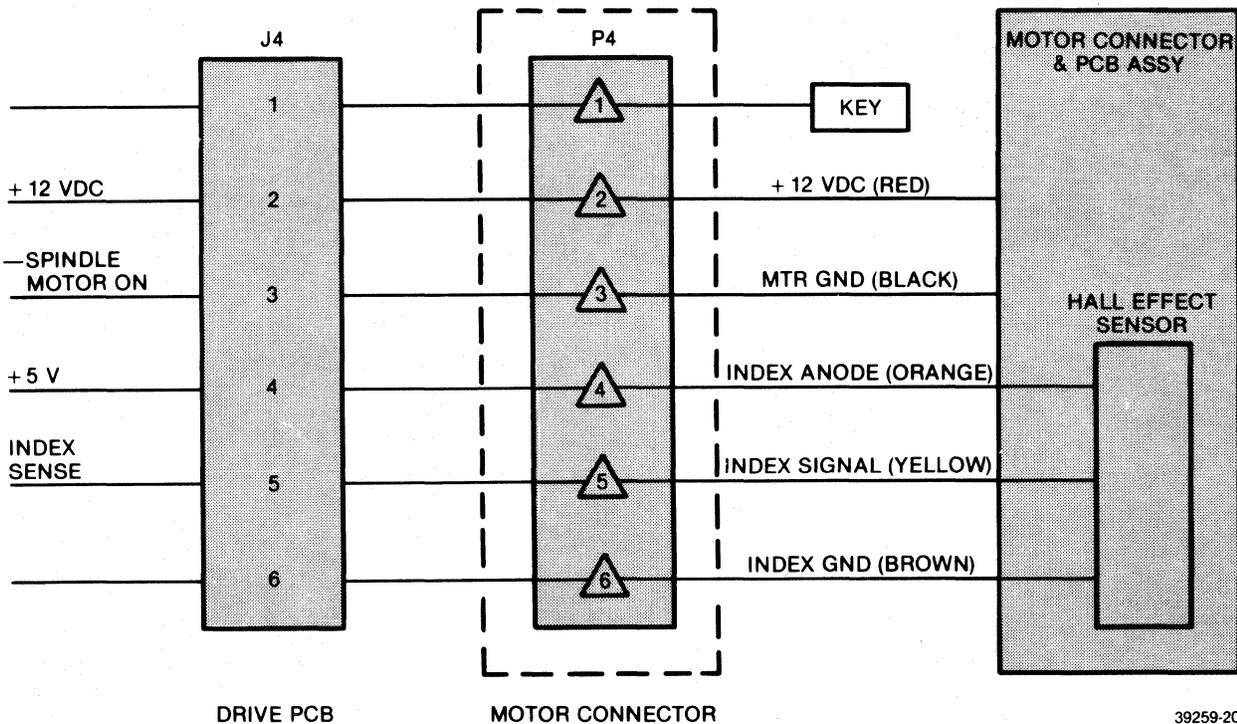
FIGURE 10-2. SPINDLE MOTOR HARNESS CONNECTIONS
