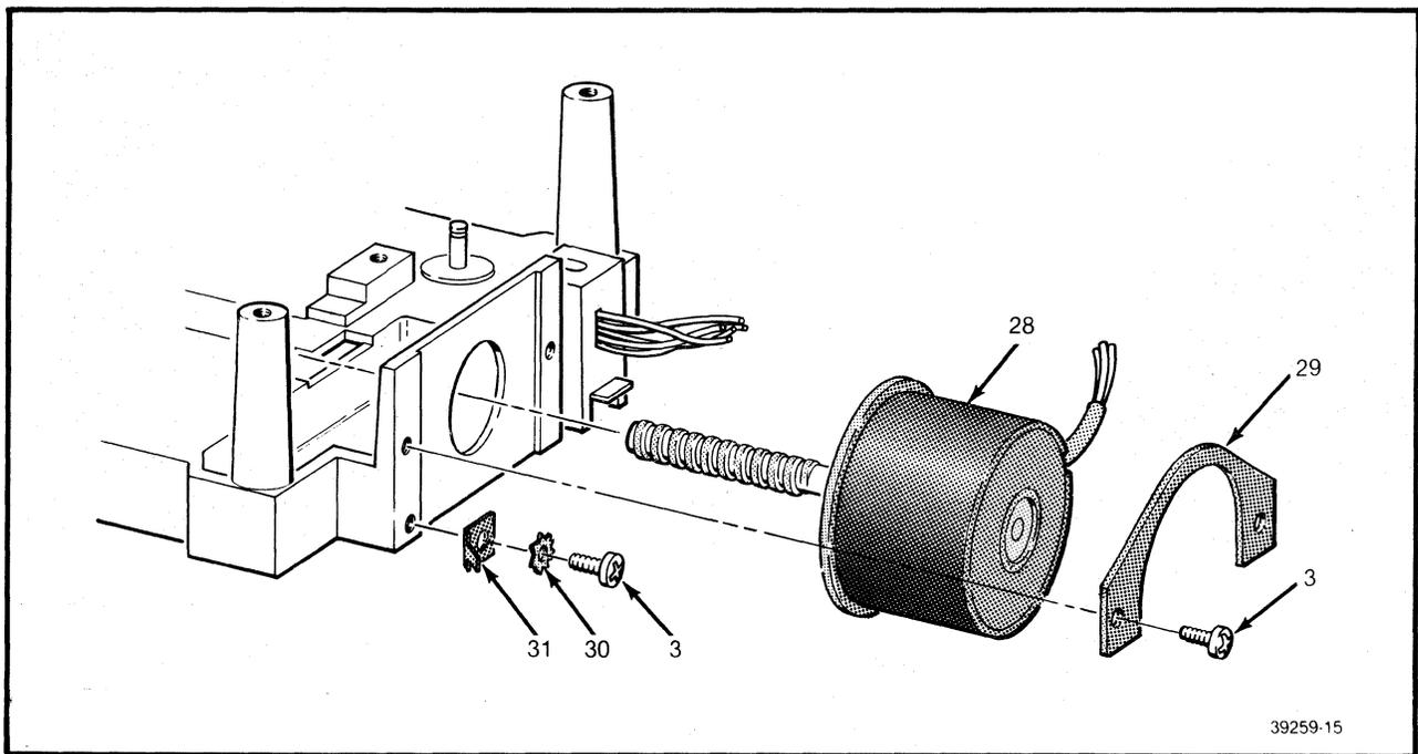
**FIGURE 7-4. STEPPER MOTOR ASSEMBLY**
