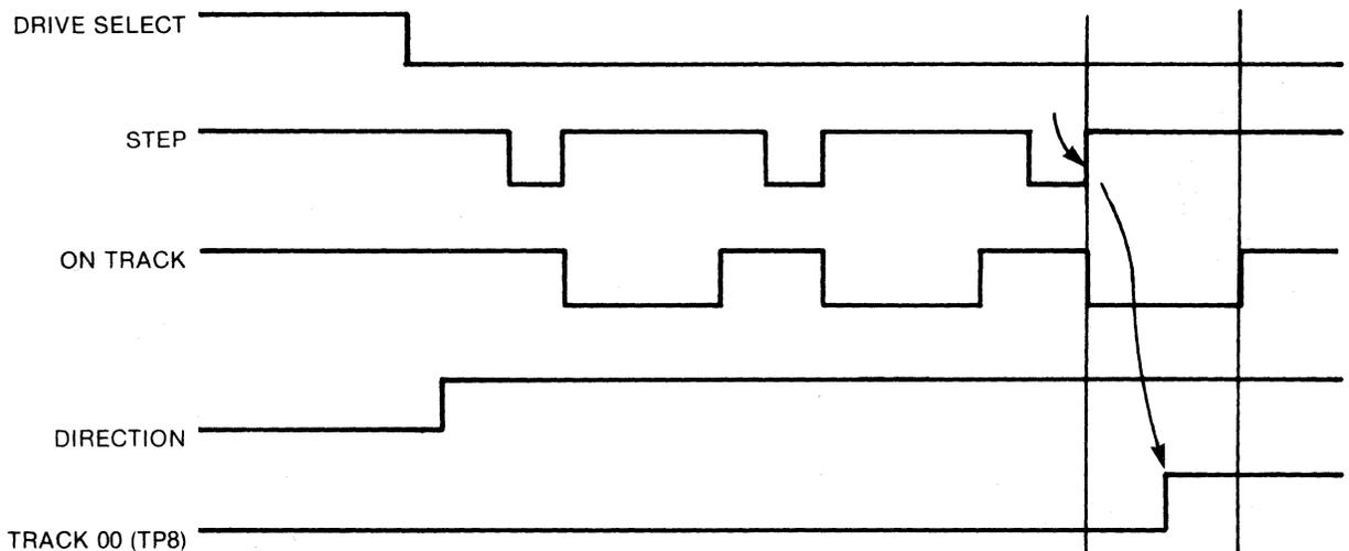
**FIGURE 2-4. TRACK ZERO TIMING**
