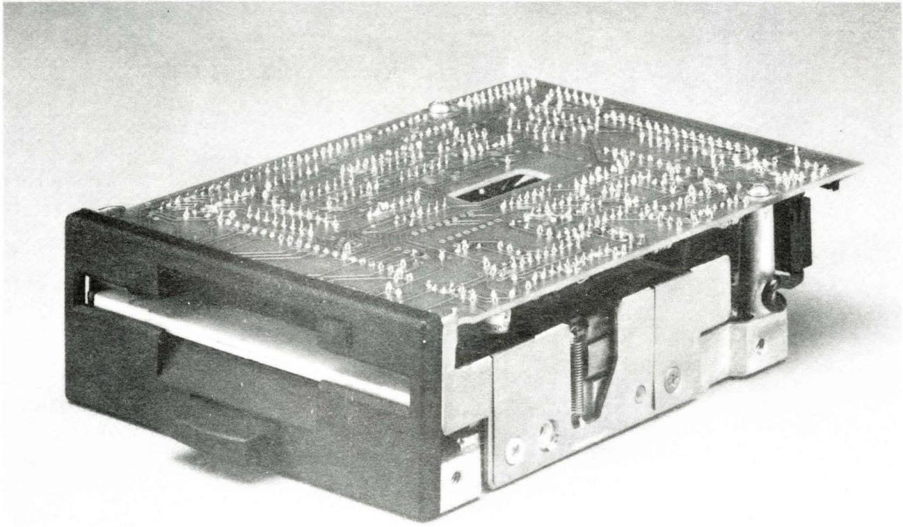
**FIGURE 1-1. SA300 SINGLE-SIDED 3.5-INCH MICROFLOPPY DISK DRIVE**
