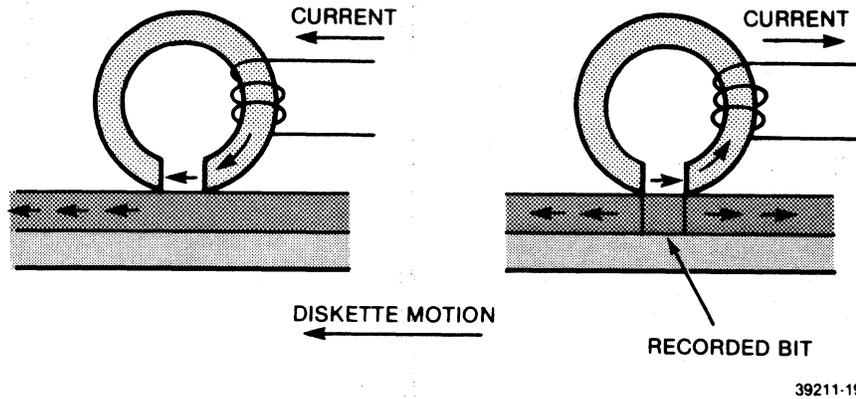
FIGURE 4-3. RECORDING A BIT
